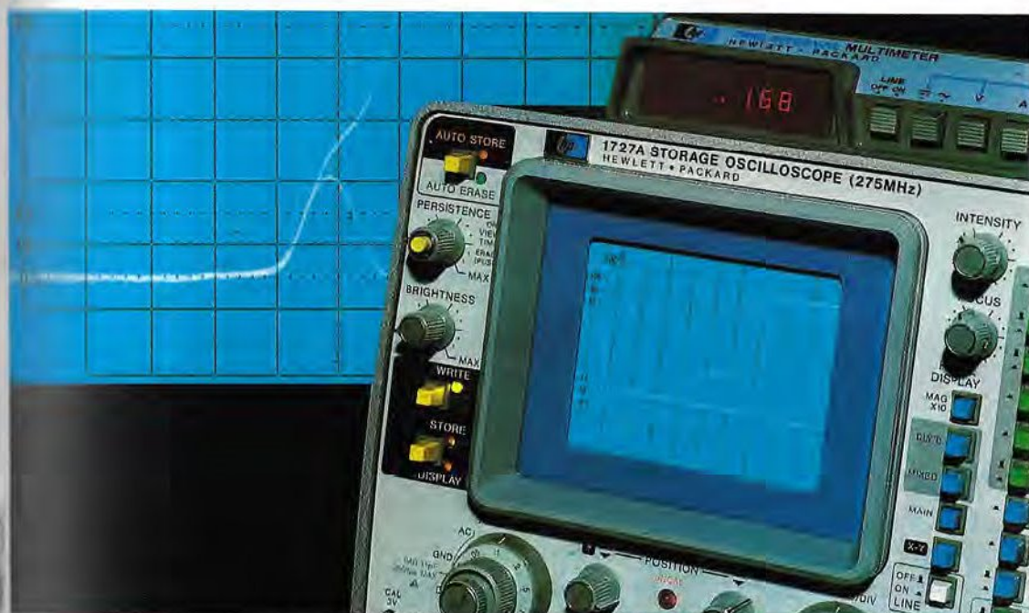
Osciloscopio Hewlett Packard que muestra las formas de onda de señales digitales.
