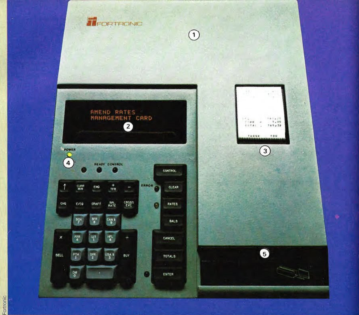
Terminal bancario (1) con display (2); impresora (3); teclado (4); lector de fichas magnéticas (5).
