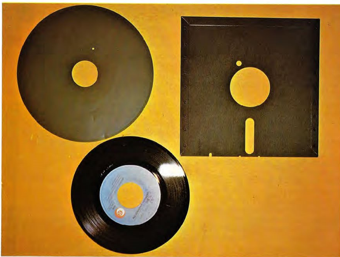
Floppy comparado con un disco normal de 45 r.p.m. En el floppy caben alrededor de 1.200.000 caracteres.
