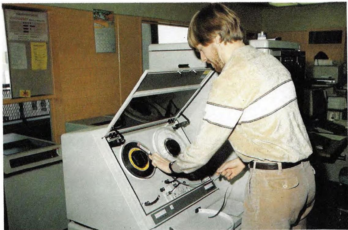
Operación de carga de una bobina en la unidad de cinta.
