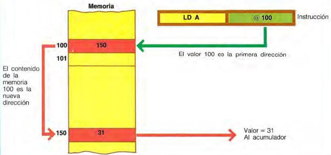
ésta cargará en el acumulador no el contenido de la memoria de dirección 100, sino el contenido de la celda de memoria cuya dirección está contenida en la celda 100, como se muestra arriba. La celda 100 contiene la dirección 150; el dato cargado en el acumulador será 31, o sea el contenido de la celda 150. En el ejemplo se ha adoptado el símbolo @ para especificar el modo de direccionamiento indirecto.
