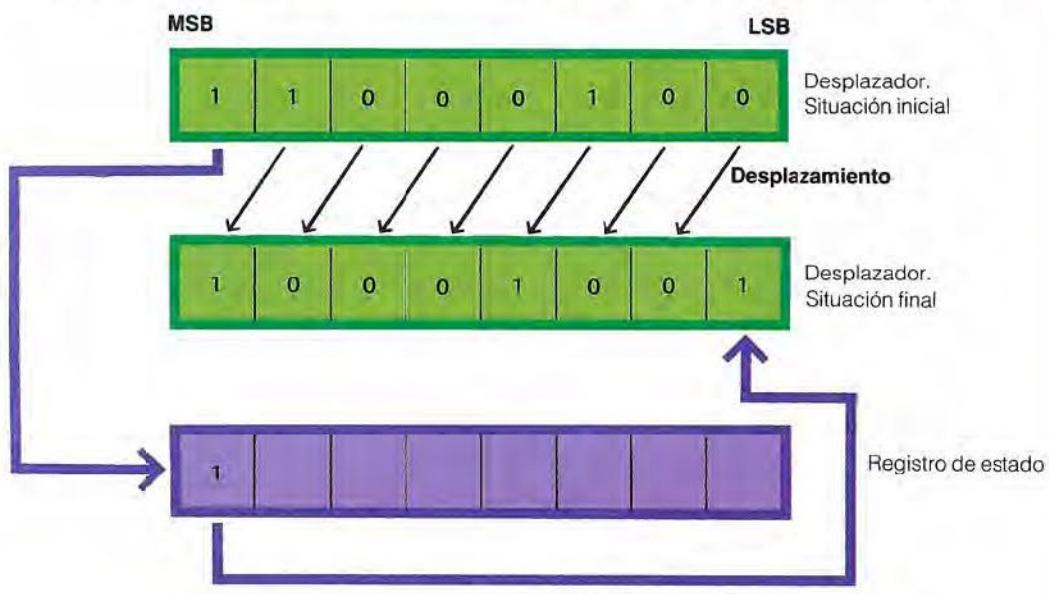
Después del desplazamiento, en el LSB del desplazador se transfiere el contenido del acarreo. Esto equivale a un desplazamiento «circular» del contenido: MSB se convierte en LSB, y todos los demás bits se desplazan una posición a la izquierda
