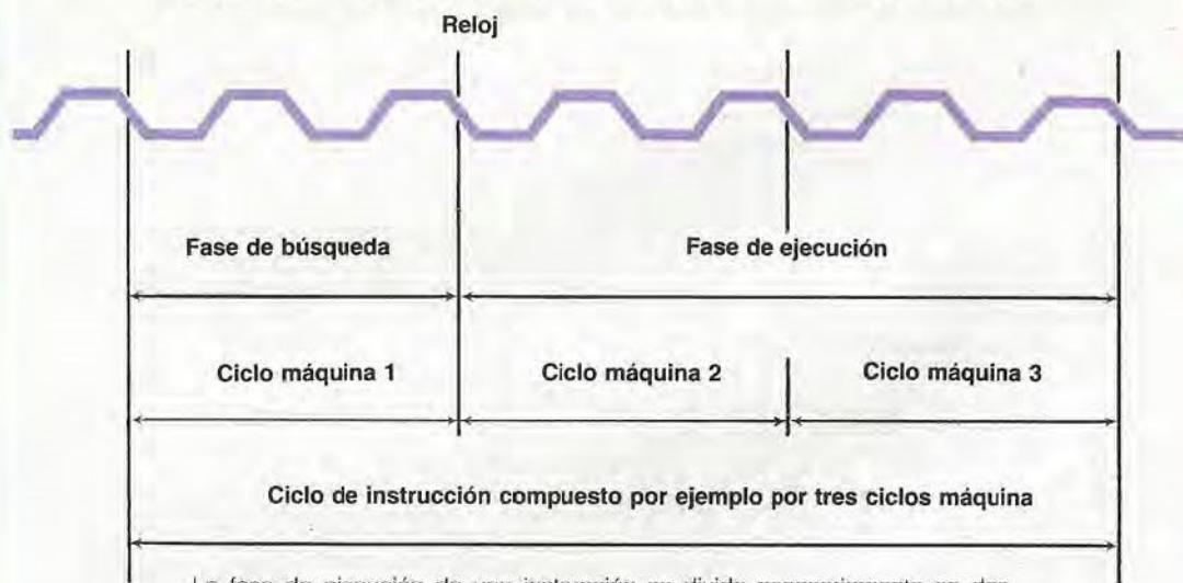
La fase de ejecución de una instrucción se divide necesariamente en dos partes principales: la fase de búsqueda y la fase de ejecución. Durante la búsqueda (un ciclo máquina) se toma el código de la instrucción, y durante la ejecución (que ocupa el número de ciclos máquina dependiente del tipo de instrucción) se activan todas las señales necesarias (bus de datos, direcciones, controles) para la ejecución efectiva de la instrucción.
