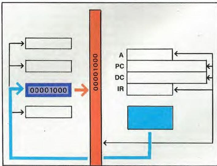
5 Al final de la operación de desplazamiento, el contenido del desplazador se transfiere al bus de datos interno
