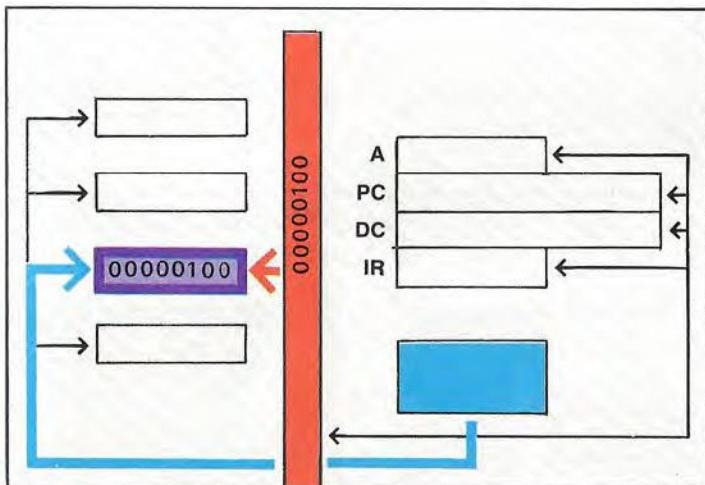
**3** La siguiente señal de control activa la transferencia del dato desde el bus al circuito de desplazamiento (interno a la ALU)
