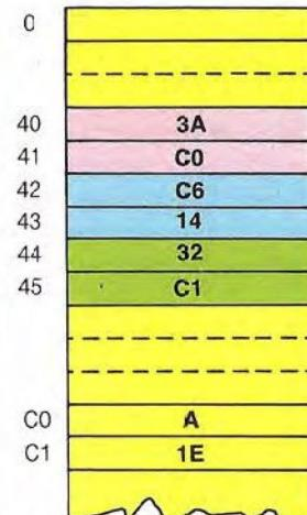
**9** Tercer ciclo de máquina de la tercera instrucción. La CPU toma el contenido del acumulador y lo deposita en la celda direccionada por el CD. Esta operación concluye la ejecución de programa.
