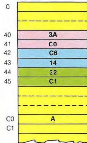
**8** La instrucción se descodifica: el sistema debe transferir el contenido desde el acumulador a la dirección que sigue al código de instrucción. La CPU descarga en el bus de datos el contenido del CP. Después de un ciclo de máquina, el valor C1 se cargará en el CD, dada su naturaleza de dirección y el tipo de instrucción.
