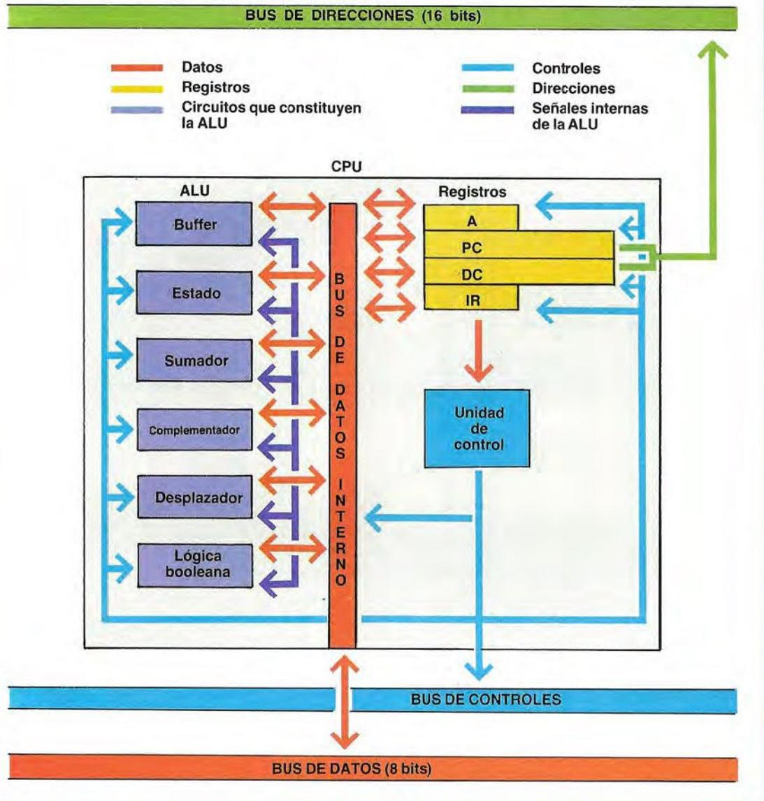
En base al tipo de instrucción, o sea según el código binario contenido en IR, la unidad de control genera una secuencia de señales de habilitación que permite a los elementos de la ALU recibir los datos en el preciso instante en que son llamados para realizar sus funciones.
