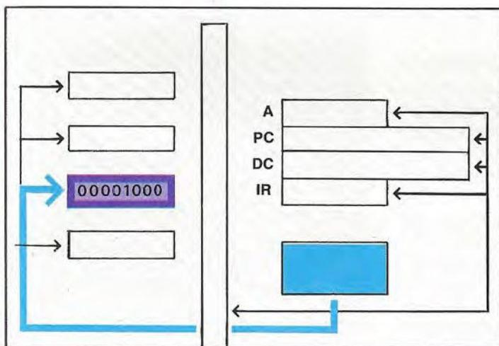
**4** A continuación del envío de una nueva señal por parte de la unidad de control, el contenido del circuito de desplazamiento se desplaza una posición a la izquierda; la última posición a la derecha (LSB, bit menos significativo) se iguala a cero
