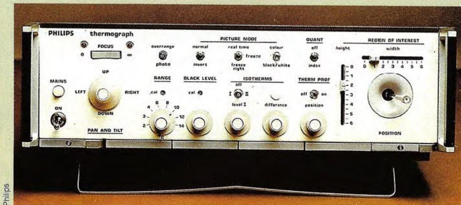
**El panel de mando y de control de un aparato para la termografía de imágenes digitalizadas. A la derecha pueden verse el joystick de posicionado y los cursores de delimitación del campo de observación.**
