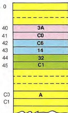
**7** En este punto se termina también el segundo ciclo de instrucción y se inicia el tercero. El contenido del CP se descarga en el bus de direcciones. Después de un ciclo de máquina, la memoria deja disponible el código de instrucción que se carga en el RI. El CP se incrementa
