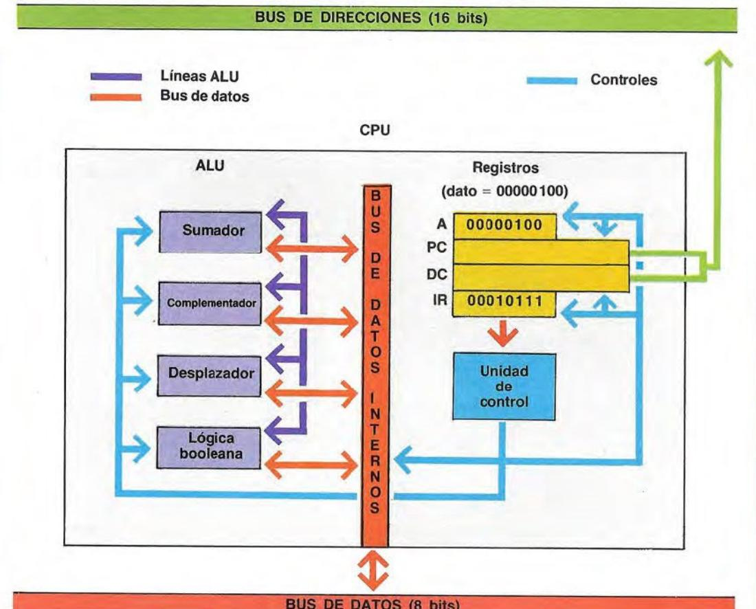
1 Estado inicial de la CPU. El acumulador A contiene el dato a desplazar, y el registro de instrucciones IR contiene el código de la instrucción a realizar (desplazamiento a la izquierda)
