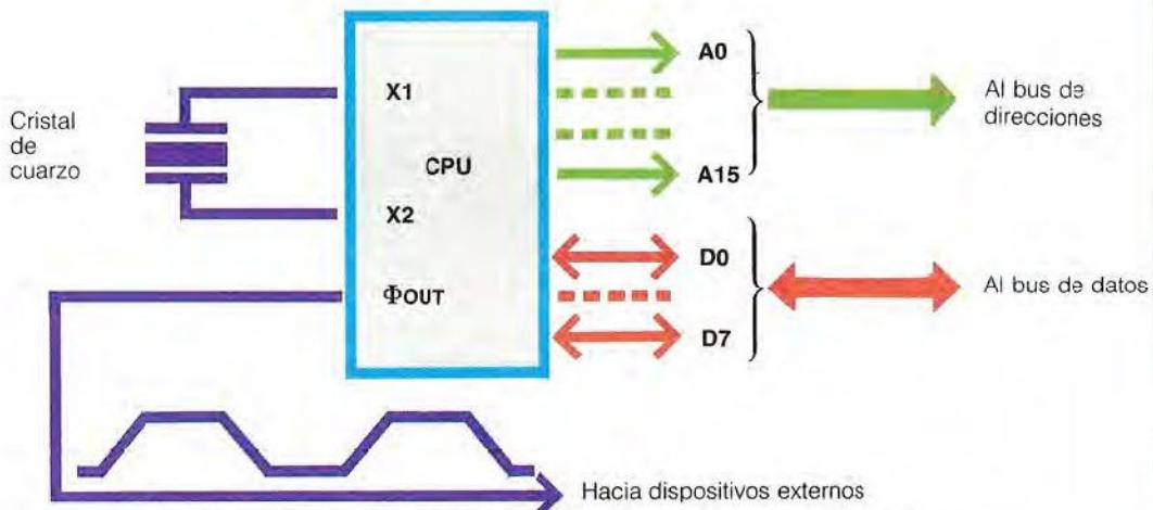
Oscilador de reloj integrado en la CPU. En este caso no hay la conexión  $\Phi_{IN}$ , puesto que la señal correspondiente es interna a la CPU. Además, acompañan a las dos conexiones X1 y X2 para el estabilizador de cristal de cuarzo
