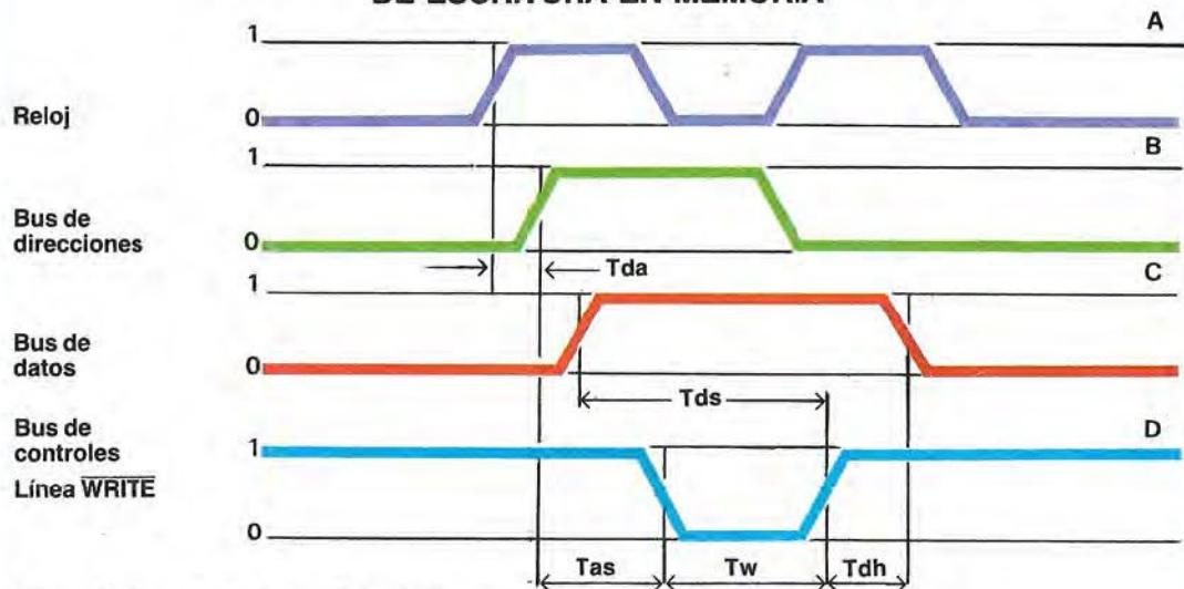
**Tda** = Address delay time = Retardo necesario para la aparición de la dirección
