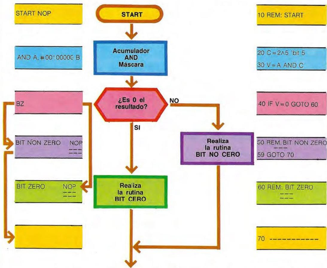
El código NOP significa No Operation. Cuando lo encuentra, el microprocesador no realiza ninguna acción (tiene un significado similar al REM del Basic). En la figura se ha representado el equivalente Basic del programa, que sólo tiene valor indicativo, puesto que con el nombre simbólico A se entiende cualquier variable y no el acumulador, como sucede en el Assembler
