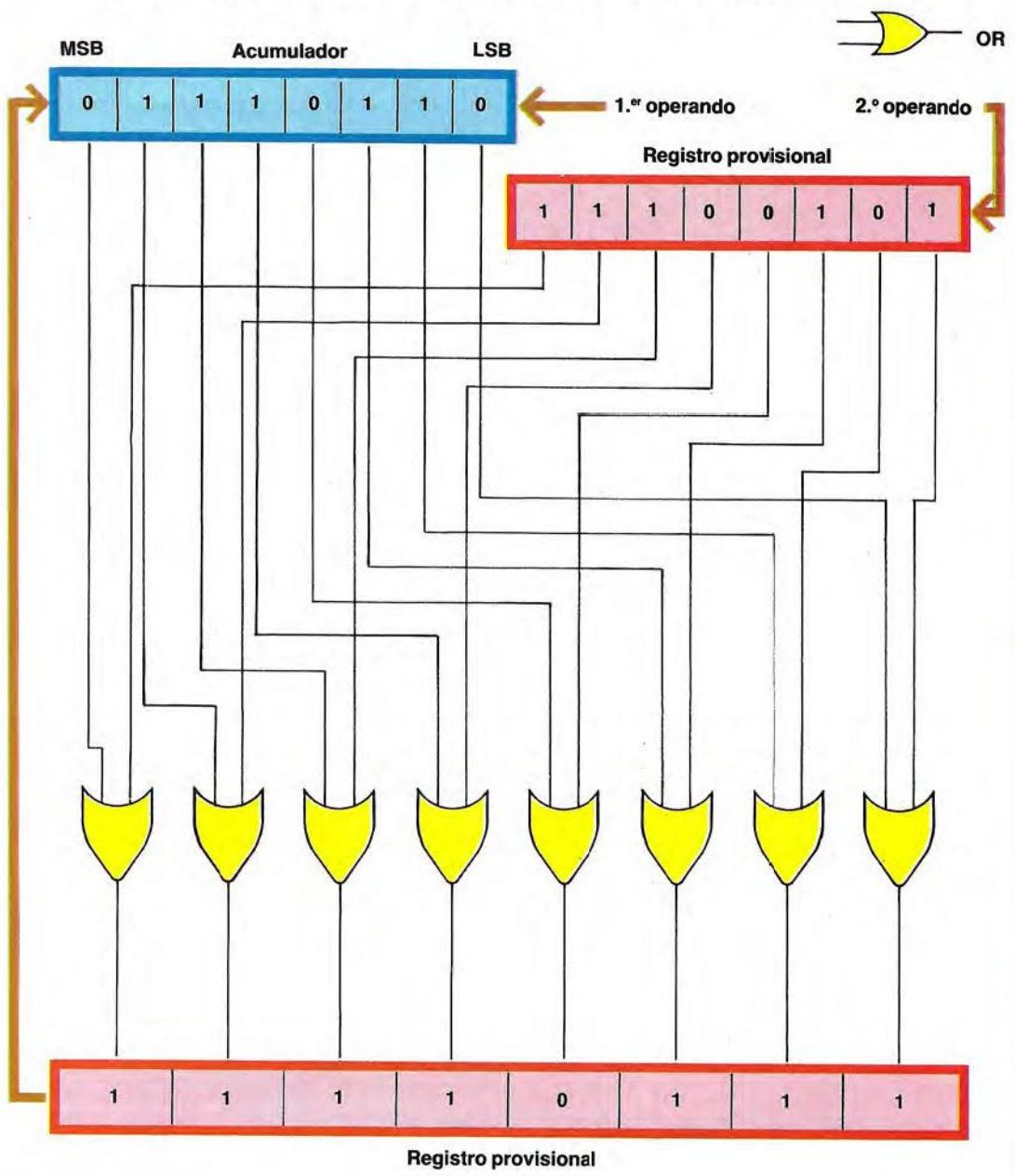
En cambio, la operación OR puede obtenerse como se muestra arriba, donde los operadores AND se han sustituido por operadores OR.
