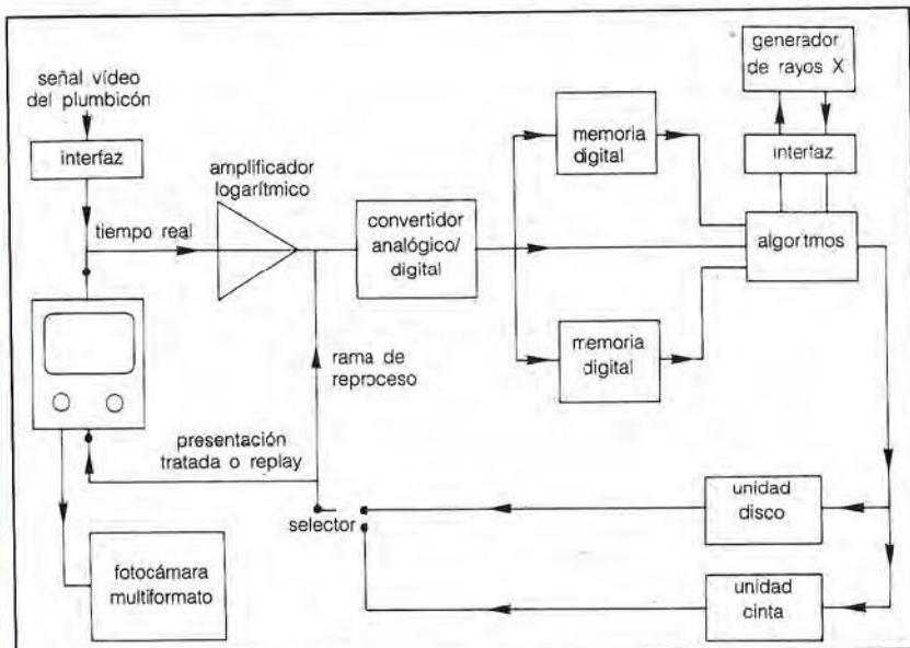
A la izquierda puede verse el esquema de bloques funcionales del aparato. En A, el serial imaging mode, en B el continuous imaging mode, en C el time interval difference mode (TID) y en D el post processing mode, que puede intervenir sobre las imágenes procesadas con uno de los algoritmos anteriores.
