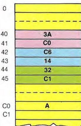
**4** La dirección contenida en el CD se descarga en el bus de direcciones. Inicia un nuevo ciclo de máquina al final del cual el valor  $(A)_{16}$  se carga en el acumulador. Al final se incrementa el contenido del CP. En este momento, la primera instrucción se ha realizado. Por tanto termina el primer ciclo de instrucción, que ha necesitado tres ciclos de máquina
