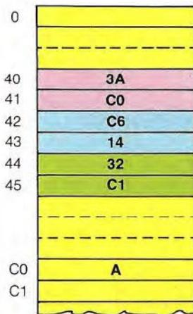
**5** Inicia el segundo ciclo de instrucción. La dirección contenida en el CP se envía al bus de direcciones. Después de un ciclo de máquina, la memoria deja disponible el contenido de la celda direccionada en el bus de datos (C6). El código C6 se cancela en el RI, y el valor del CP se incrementa
