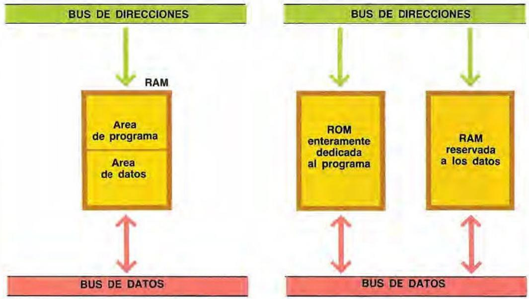
En la pág. 868 se ha representado un ejemplo de cómo podría estructurarse y realizarse este programa en un microprocesador de 8 bits. Como ya se vio al hablar de los sistemas con microcalculador (págs. 125 y siguientes), un microprocesador comprende en su interior diversos dispositivos que le permiten realizar un determinado conjunto de instrucciones según una precisa secuencia de pasos.
