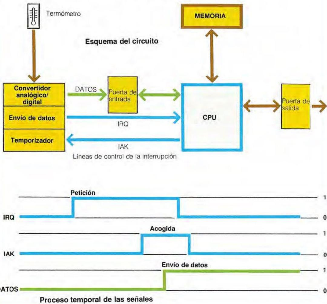
al valor lógico 1 la línea IAK. A la recepción de la señal IAK, el dispositivo externo envía a los dispositivos de entrada el dato que representa la medición de temperatura y anula la petición de interrupción poniendo a 0 la línea IRQ.
