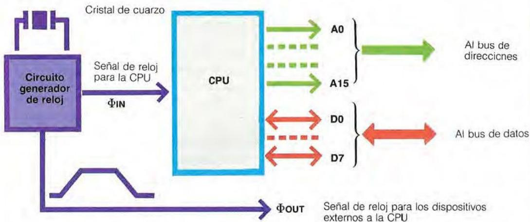
CPU con oscilador externo. La señal de reloj se genera con un componente externo especializado
