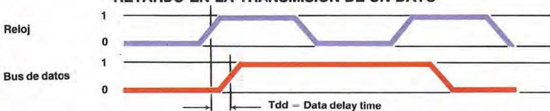
Tiempo de retardo entre el reloj y la aparición del dato. La aparición de la señal de reloj (la línea pasa del nivel 0 al nivel 1) activa la función a realizar, pero a causa de los fenómenos físicos presentes, las correspondientes señales eléctricas aparecen sólo después de cierto tiempo. Por tanto se tiene un retardo entre el comando (salida del reloj) y la ejecución (aparición de la señal correspondiente al dato)
