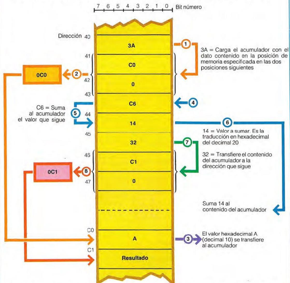
En este ejemplo se han utilizado dos tipos diferentes de instrucción de carga. En la primera, la del código 3A (Carga el acumulador), los datos se toman a través de un direccionamiento a una posición cualquiera de memoria (en el ejemplo C0), también distante de la que contiene la instrucción. El segundo tipo (inmediato, código C6) utiliza como dato (en el ejemplo 14) el contenido de la memoria que sigue a la que contiene el código de instrucción
