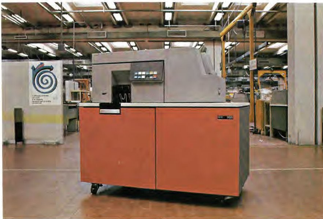
Perforador de fichas IBM 3525. Es uno de los periféricos estándar de salida de ordenador.
