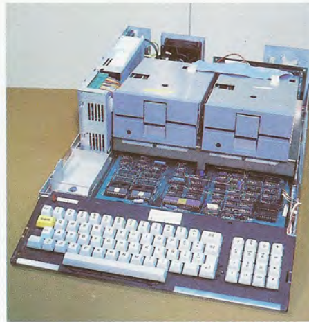
El mueble del equipo dispone de espacio para alojar un máximo de dos unidades de disco flexible o una unidad de disco flexible y otra de disco rígido de tecnología Winchester con capacidad de 11 Mbytes.
