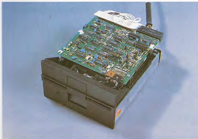
Las dos unidades de disco incorporadas al equipo son para discos de 5 y 1/4 pulgadas con una capacidad de 102 Kbytes por disco.
