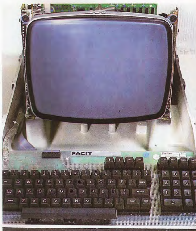
El teclado puede seleccionarse para la generación de los caracteres propios de determinados idiomas, entre ellos el castellano, actuando sobre una red de microconmutadores internos.
