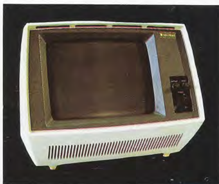
La pantalla de 12 pulgadas que forma parte del terminal estándar es monocromática de fósforo verde con una capacidad de 1.920 caracteres distribuidos en 24 líneas de 80 caracteres.
