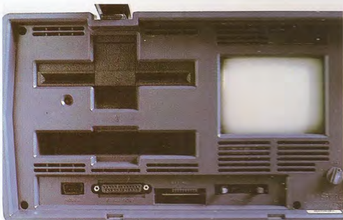
La minipantalla de 5 pulgadas incorporada al equipo es monocroma de fósforo verde en la versión europea. La presentación corresponde a una ventana de 24 líneas de 52 caracteres que se desplaza a través de la página de visualización.
