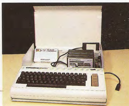
Para poder disponer de la máxima capacidad de memoria Commodore ha diseñado una carcasa de ampliación que permite la conexión de diversos módulos externos.
