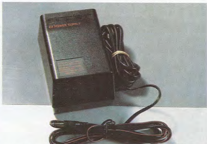
La tensión continua de 9 voltios necesaria para el funcionamiento del Spectrum la suministra la fuente de alimentación, conectable a la red, que acompaña al equipo.
