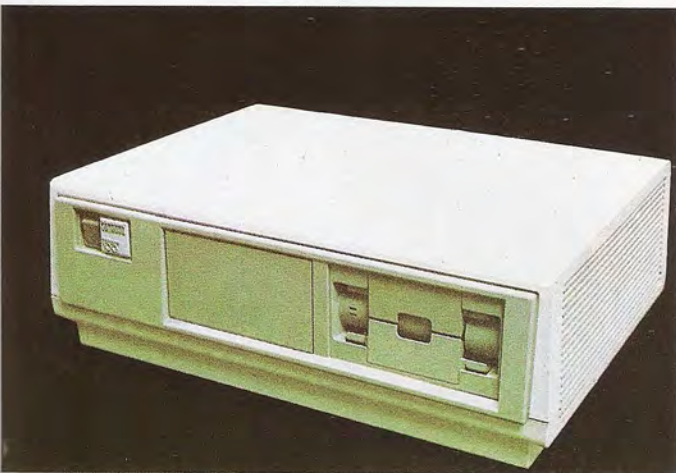
Unidad central está basada en dos microprocesadores: el Z80 de 8 bits y el 8088 de 16 bits, dotando a la unidad central de una capacidad de proceso eficaz para la ejecución de programas creados tanto para CPU de 8 como de 16 bits.
