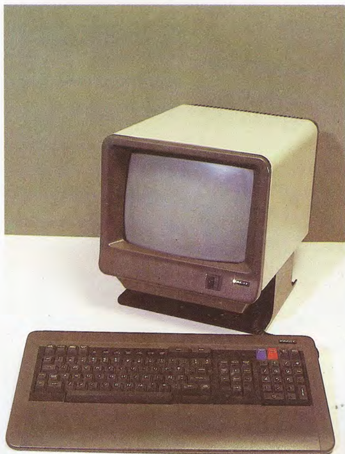
El terminal FACIT 4420, de diseño sobrio y funcional, está controlado internamente por un microprocesador de 8 bits del tipo F-8 de la firma Fairchild.
