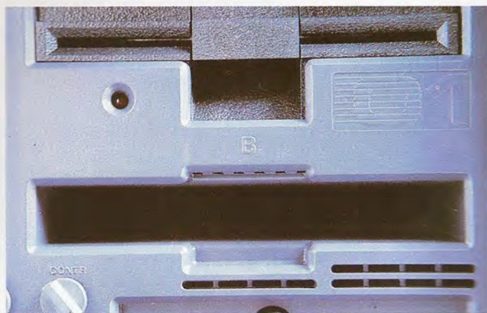
Debajo de las bocas de acceso a las dos unidades de disco existen sendos receptáculos para almacenar los discos flexibles. Los conectores para comunicaciones están situados justamente debajo de los citados receptáculos.
