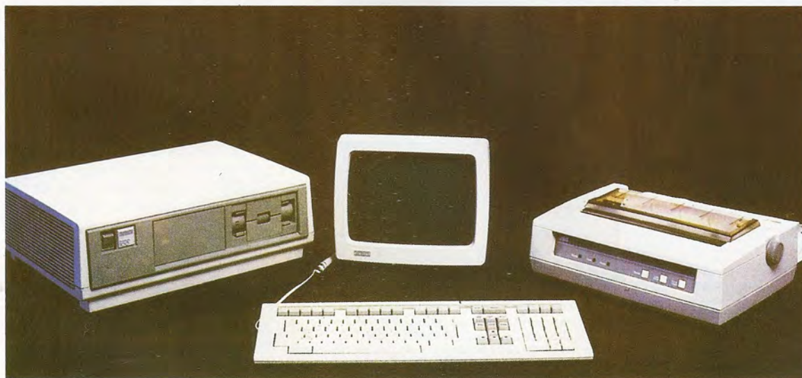
La aplicación de contabilidad general «PLACON», creada para el RAINBOW PC-100, se implementa en un sistema constituido por la unidad central, teclado, pantalla, doble unidad de disco flexible e impresora.
