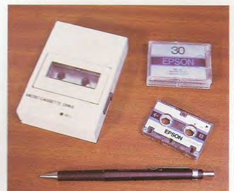
Unidad de minicinta: realiza una función análoga a la del magnetófono, si bien, es capaz de operar con mayor velocidad.
