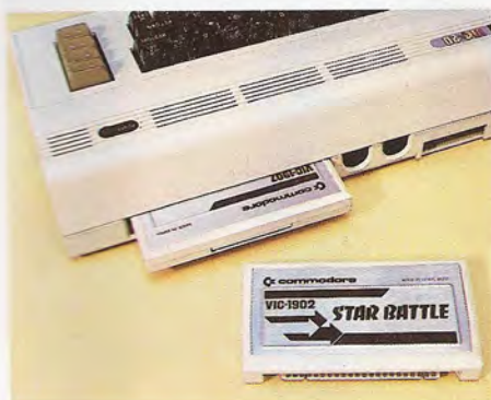
En la parte posterior de la carcasa, pueden conectarse directamente los cartuchos con programas de juegos o de ayuda de programación.
