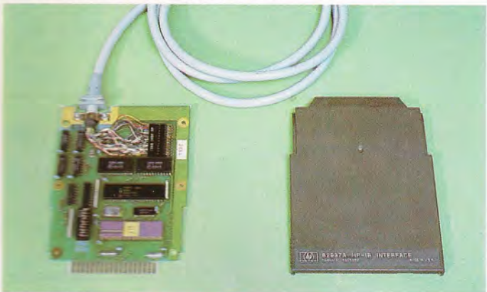
Las posibilidades de adaptación de equipos periféricos se disparan con la conexión al HP-86 del módulo de interface HP-IB. Este da acceso a un total 12 x 4 dispositivos periféricos en el modelo HP-86A y a 12 x 5 en la versión HP-86B.
