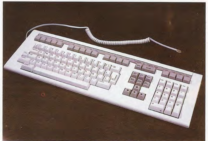
El conjunto de teclas está distribuido en varios bloques; el primero de ellos es el teclado alfanumérico de tipo QWERTY, junto al que se encuentra las teclas para el movimiento del cursor y el teclado decimal. El conjunto se completa con una red de teclas de función.
