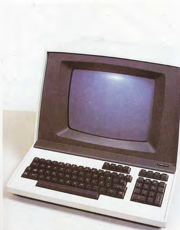
El Facit 4411 es un terminal compacto, con monitor monocromo, diseñado pensando en su actuación como periférico básico de sistemas de gestión.
