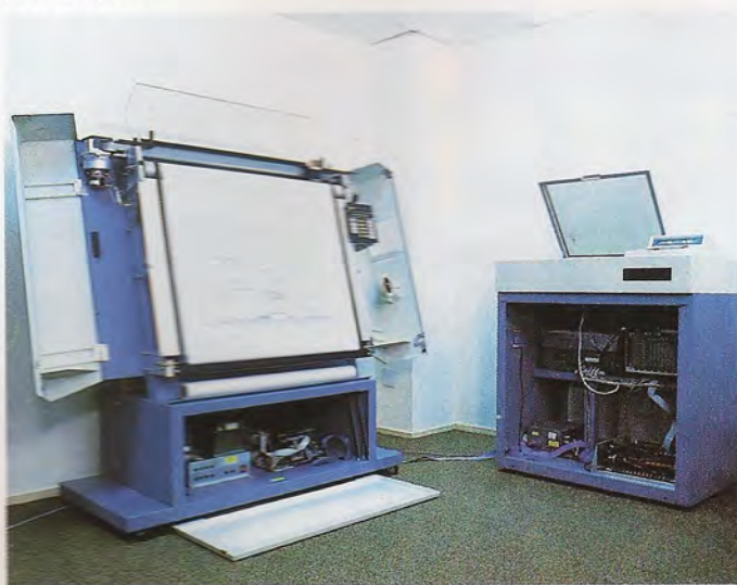
El plotter 965 es un trazador gráfico de tipo «beltbed» o mesa inclinada.
