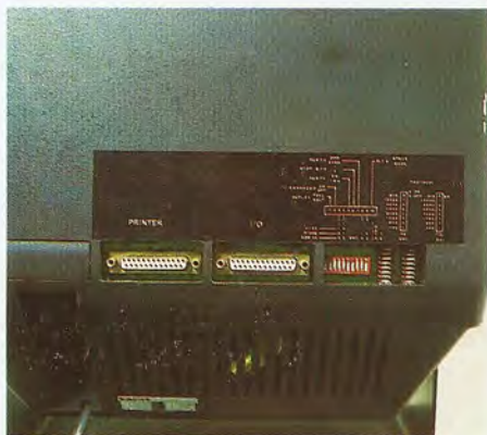
Panel posterior del terminal FACIT 4420, donde pueden observarse los distintos conectores de comunicación del sistema y la red de microconmutadores de selección.
