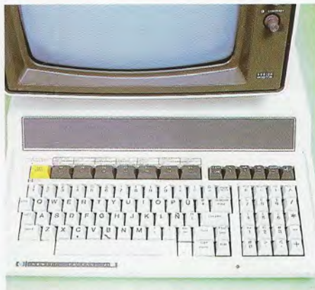
El teclado dispone de un total de 91 teclas, distribuidas en teclado alfanumérico, teclado numérico decimal, teclas para el control del cursor y zona de teclas funcionales.
