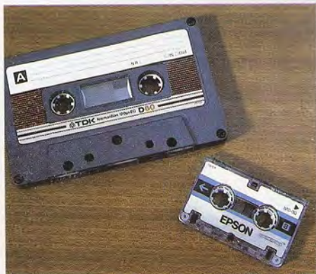
La fotografía muestra los dos tipos de cassettes convencionales más comunes, diferenciados por su tamaño. Los mayores se emplean para la reproducción de sonido; los más pequeños suelen estar orientados al almacenamiento de información digital.
