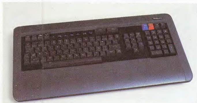
El teclado del terminal utilizado (FACIT 4420) es del tipo QWERTY y consta de un total de 96 teclas, distribuidas en varias zonas: teclado alfanumérico, teclado decimal, teclas de control de cursor y teclas para el control del terminal.
