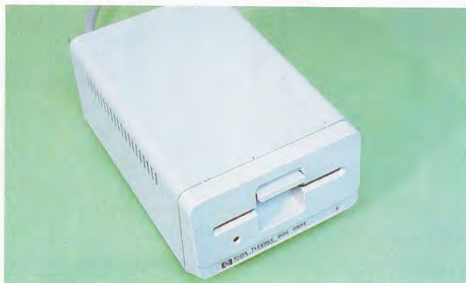
En la versión básica, el HP-86 puede controlar directamente a dos unidades de disco flexible de 5 y 1/4 pulgadas con capacidad de 270 Kbytes por disco.
