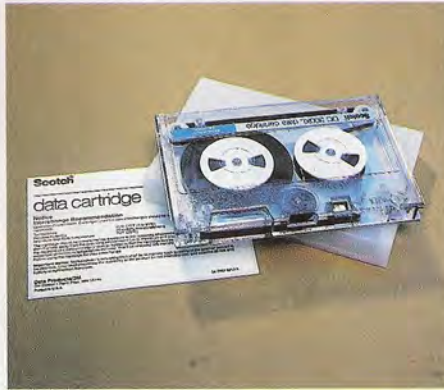
Las unidades de cartucho suelen emplearse para la obtención de copias de seguridad (back-up) de la información almacenada en discos rígidos.
