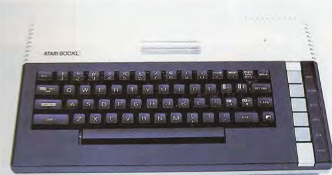
La fotografía muestra la unidad central del modelo ATARI-800 XL, idéntica al modelo 600 XL, pero con una RAM de 64 Kbytes en la versión básica.
