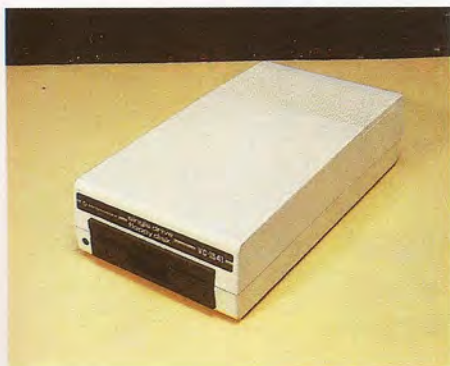
La unidad de disco flexible VIC-1541 permite almacenar los programas en disquetes de 5 1/4" con una capacidad de 170 Kbytes.
