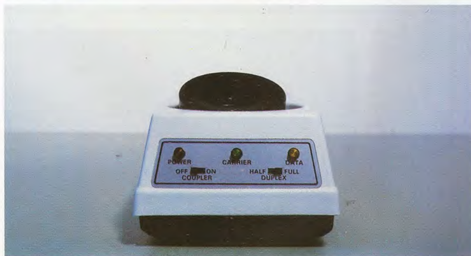
Un modem de tipo común, como el de la fotografía, incorpora en el panel frontal algunos indicadores (de conexión, de detección de portadora y de presencia de datos) y conmutadores (conexión/desconexión del acoplador acústico y selección half/full duplex).
