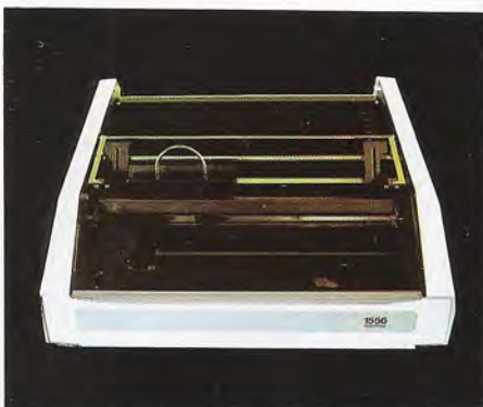
Las dos impresoras que se ofertan para el sistema son las Secoinsa 1555 y 1556. Esta última dispone de introductor de documentos especiales como, por ejemplo, libretas bancarias.
