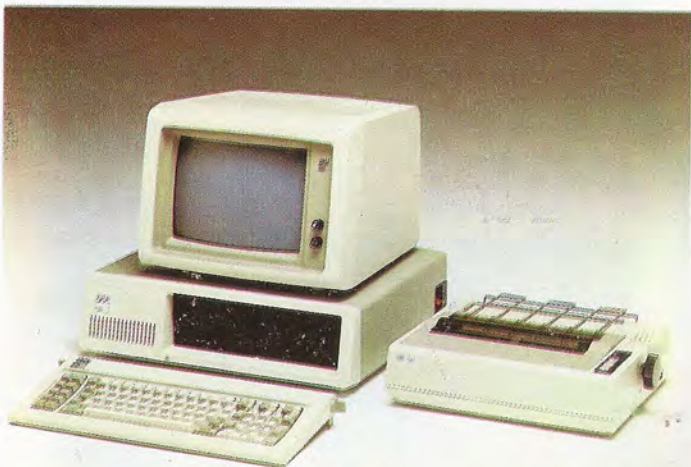
La configuración más estandarizada del IBM-PC consta de la unidad central, una unidad de disco flexible de 5 y 1/4 pulgadas, unidad de disco rígido de 5 Mbytes, teclado, monitor monocromo e impresora.
