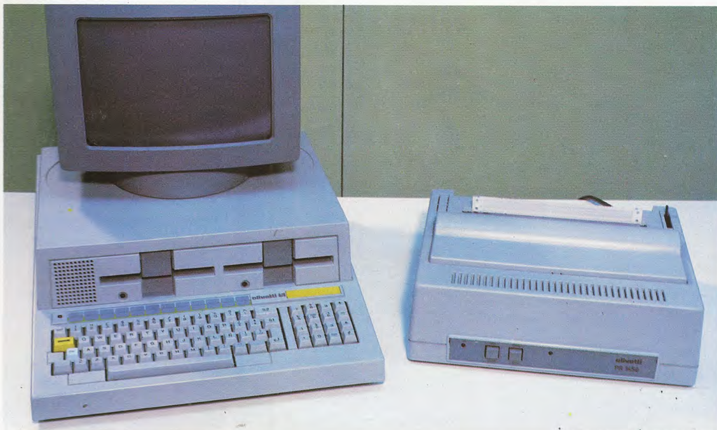
El OLIVETTI M-20 es un microordenador orientado básicamente a tareas de gestión. Su CPU está constituida por el microprocesador de 16 bits Z-8001 de la firma Zilog.
