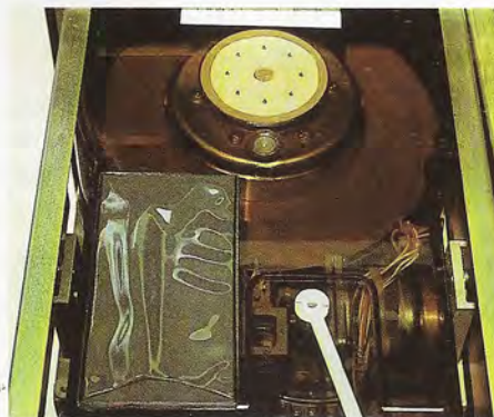
El disco rígido que forma parte de la configuración estándar posee una capacidad de 10 Mbytes. En la foto se observa el brazo de anclaje del disco rígido que actúa como sistema de seguridad al trasladar el equipo.
