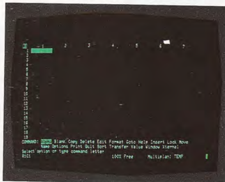
La hoja electrónica la crea el propio usuario adecuándola a cada aplicación. Este puede distribuir datos en las células definidas por la intersección de 255 filas por 63 columnas.
