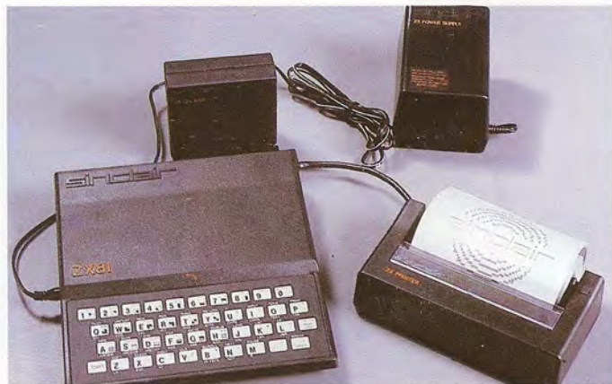
La configuración básica que aparece en la fotografía, completa con un receptor TV como periférico de visualización y con un magnetófono a cassette como memoria de masa, dan lugar a un sistema muy adecuado para empezar a familiarizarse con las técnicas microinformáticas.
