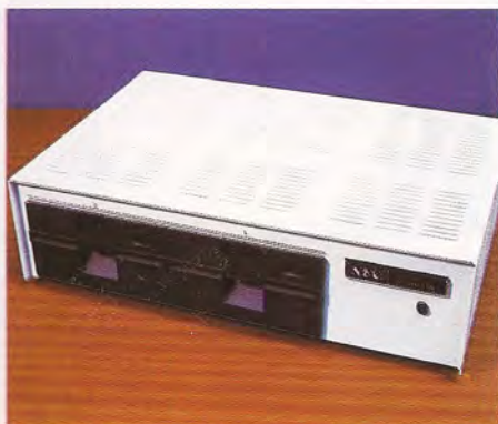
Unidades de disco flexible: estos son los periféricos de almacenamiento más habituales en el campo de los microordenadores.
