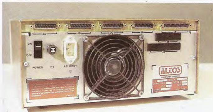
En el panel posterior de la unidad central están dispuestos los conectores de comunicaciones: cuatro accesos con interface RS-232C y un acceso para comunicación en formato paralelo.
