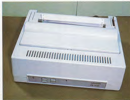
Como opción básica Olivetti ofrece para el M-20 la impresora PR-1450. Esta es una impresora de matriz de puntos, de 80 a 132 caracteres por línea, capaz de operar a una velocidad de 100 c.p.s.
