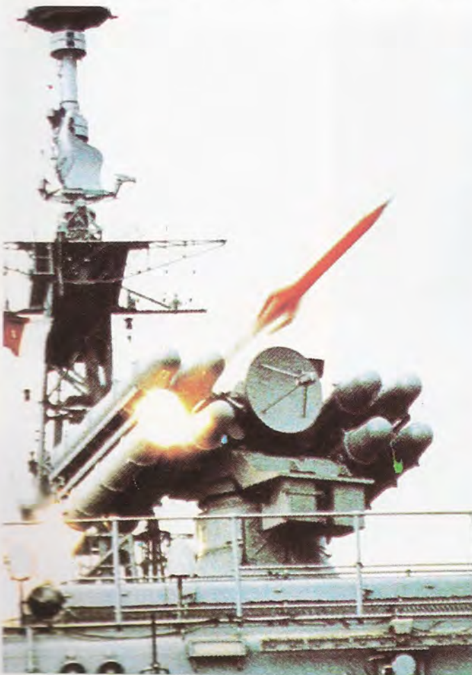
La electrónica y la informática convierten a los modernos misiles en artefactos destructores de precisión casi infalible. En la fotografía aparece una batería de misiles Crotale rodeando al sistema electrónico de telecontrol.
