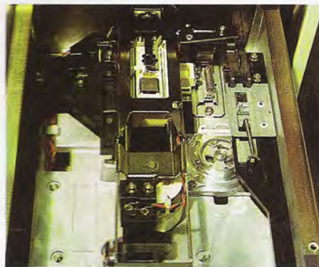
La configuración básica incluye una unidad de disco flexible de 8 pulgadas, de 1,2 Mbytes. Su función primordial es la obtención de copias de seguridad (Back-ups) de los archivos de programas y datos.
