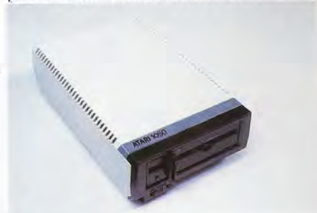
ATARI ofrece al usuario del modelo 600 XL la posibilidad de conectar hasta cuatro unidades de disco flexible de 5 1/4" con una capacidad de 127 Kbytes cada una.
