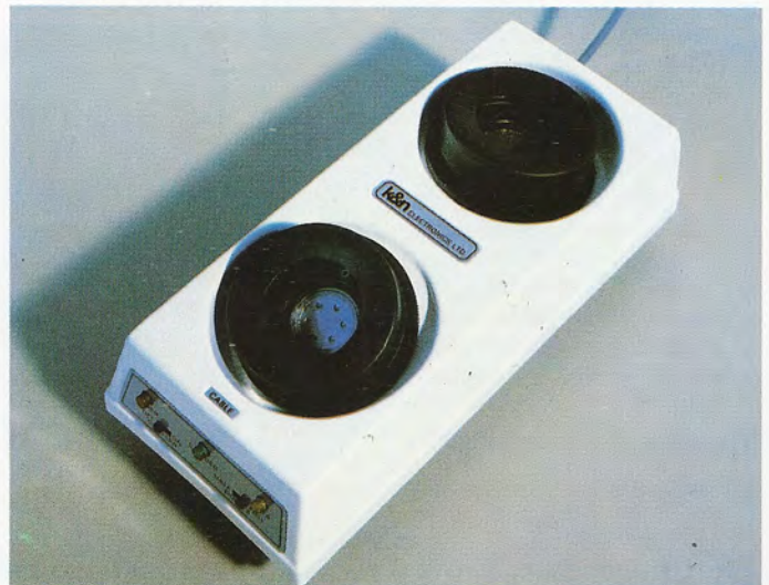
Los modems más comúnmente utilizados con los microordenadores suelen incorporar en la propia caja el acoplador acústico que les permite utilizar un simple microteléfono como medio de acceso a la línea telefónica.
