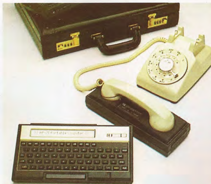
El modem (modulador demodulador) es un dispositivo periférico que se utiliza para la transmisión/recepción de datos a través de las líneas de comunicación telefónica.
