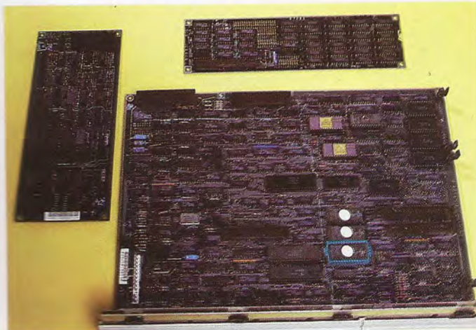
Ampliando el sistema con la expansión de comunicaciones, se dispone de una línea de alta velocidad adecuada para la conexión de una unidad externa de disco rígido, de tecnología Winchester, con una capacidad de almacenamiento de 5 Mbytes.
