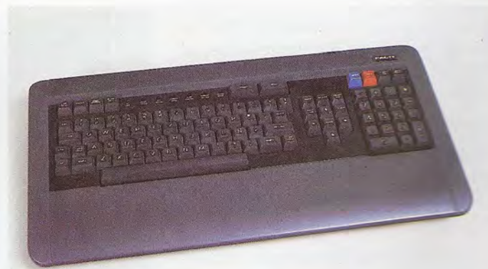
El teclado del FACIT 4420 puede incorporar los caracteres alfanuméricos de siete idiomas, entre ellos el español. Está separado de la pantalla y es de perfil bajo.
