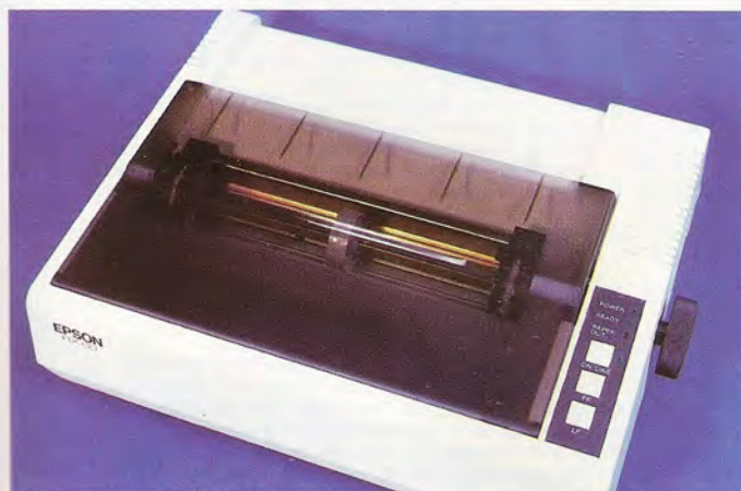
La RX-80 es una impresora diseñada específicamente para ordenadores personales, de notable economía y caracterizada por una velocidad de escritura de 100 cps.
