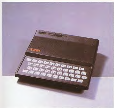
La unidad central y el teclado (sensible al tacto) están alojados en una misma caja de plástico de dimensiones mínimas.
