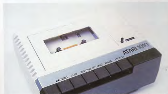
La unidad de cassette 1010 conectable al ATARI-600 XL tiene una capacidad de 100 Kbytes, para una cinta convencional de audio de una hora de duración, en un formato de cuatro pistas y dos canales. La unidad ha sido diseñada especialmente para el almacenamiento de datos digitales.
