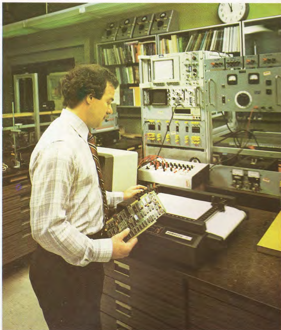
Los plotters o trazadores gráficos se utilizan profusamente en el diseño de circuitos electrónicos: para dibujar el trazado del circuito impreso, el plano de montaje de los componentes...
