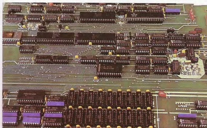
El equipo incluye tres microprocesadores: un Z-80 en tareas de procesador central, otro Z-80 para el control de operaciones DMA y el procesador para cálculos aritméticos de la Western Digital 9511.
