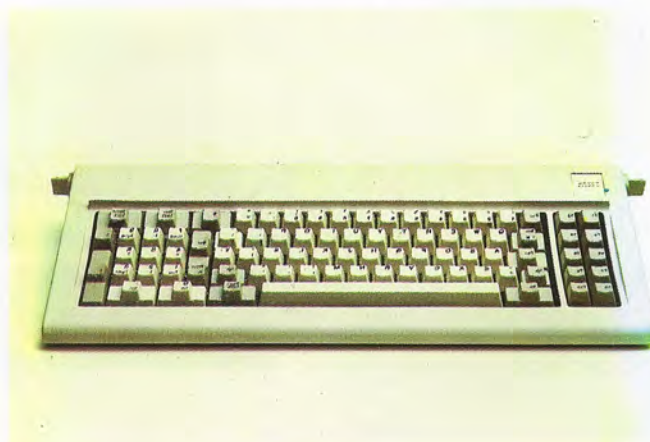
El teclado consta de un total de 83 teclas, agrupadas en tres bloques: la zona de caracteres alfanuméricos y de movimiento de cursor, el teclado numérico y la zona de teclas funcionales.
