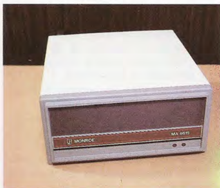
Los discos rígidos pueden ser de tipo fijo o «removible». El equipo de la fotografía es una unidad compacta de disco rígido fijo, de tecnología Winchester.
