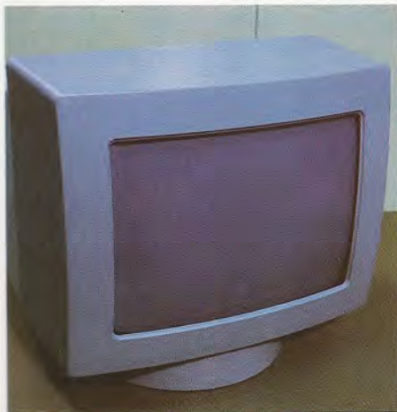
La pantalla es independiente, respecto al mueble de la unidad central. Puede optarse por monitor monócromo (de fósforo verde o blanco) o de color (ocho colores generables).
