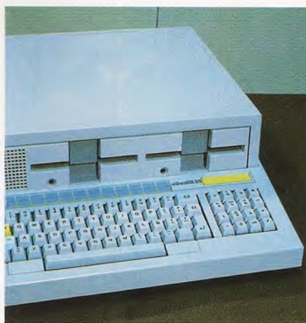
El mueble que aloja al equipo incorpora, además de la unidad central, al teclado y a una o dos unidades de disco.
