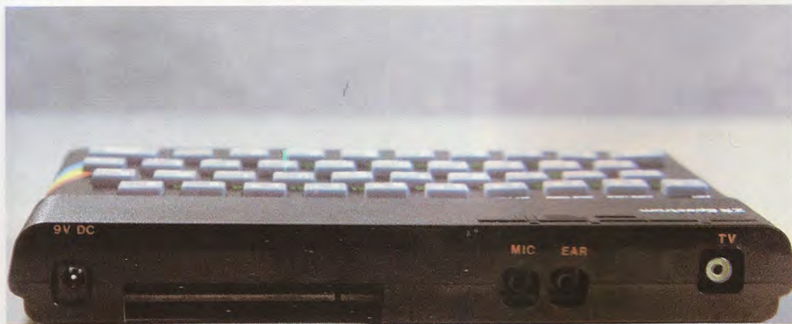
El ZX-Spectrum se presenta en una caja de plástico negro de reducidas dimensiones y en cuya zona frontal incorpora el teclado constituido por un total de 40 teclas multifuncionales.
