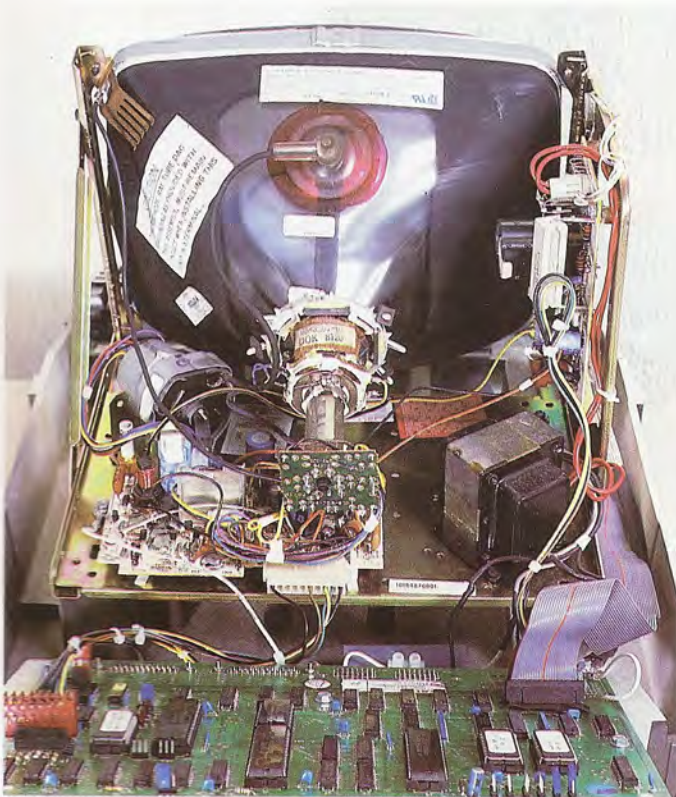
La pantalla es de fósforo verde con un diámetro de 12 pulgadas. La visualización se realiza sobre 24 líneas de 80 caracteres, cada carácter conformado sobre una matriz de 7 x 5 puntos.
