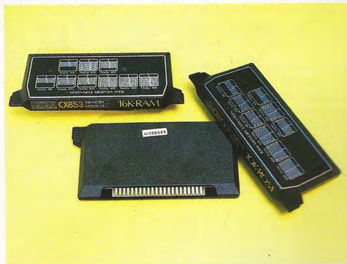
Algunos microordenadores permiten la ampliación de la memoria principal por medio de la incorporación de módulos exteriores de memoria RAM o ROM.
