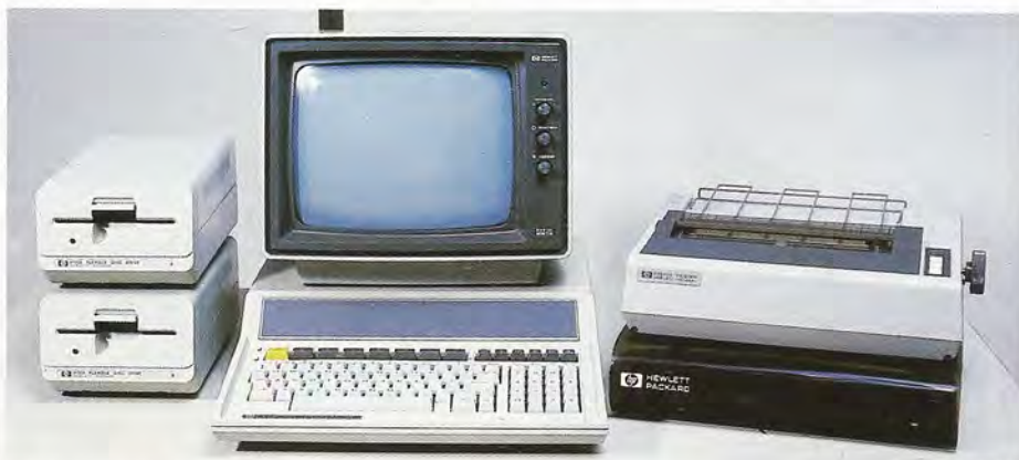
El HP-86 es uno de los ordenadores personales de la serie 80 de Hewlett Packard. Se trata de un sistema monousuario orientado básicamente a aplicaciones de cálculo e ingeniería.
