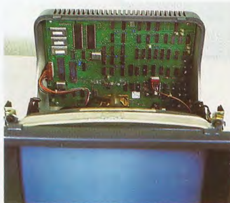
El terminal FACIT 4420 dispone de una memoria ROM de 6 Kbytes y una RAM de 2 K x 12 bits para la gestión de pantalla.
