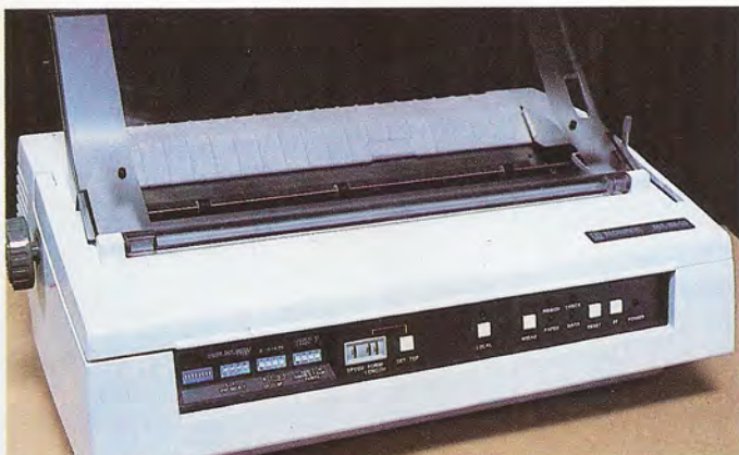
Las impresoras son los periféricos de salida más generalizados. Imprimen sobre papel la información que reciben del ordenador.
