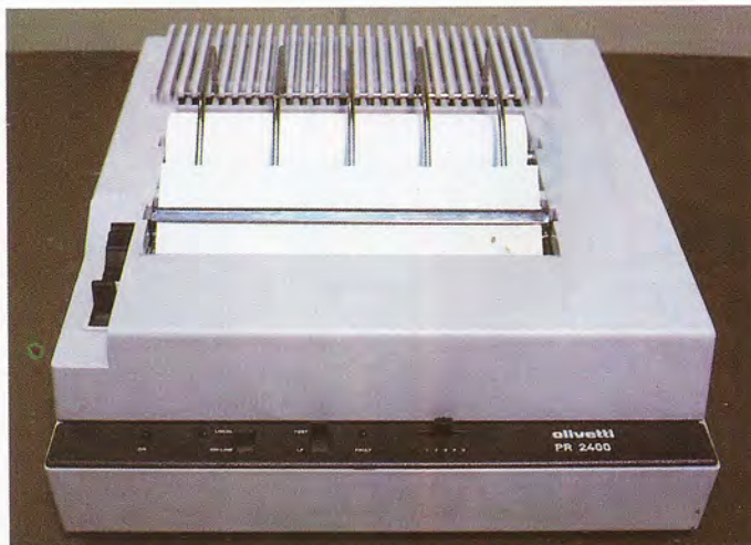
Impresora para bobinas de papel continuo con arrastre por fricción.
