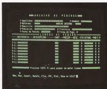
En este caso, la pantalla diseñada por medio del programa SCREEN está orientada a la creación de un archivo de pedidos. En la línea inferior aparecen los comandos disponibles.
