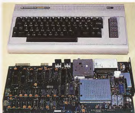
La unidad central de proceso está constituida por el microprocesador 6510 de MOS Technology, un chip microprocesador compatible con el ya clásico 6502 de la misma firma.
