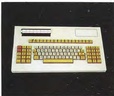
El teclado del terminal IS 9502 está distribuido en tres bloques: zona alfanumérica de tipo QWERTY, teclado numérico decimal y zona de teclas funcionales.
