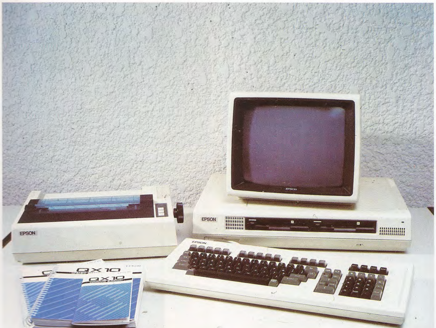
La unidad central del EPSON QX-10 puede soportar, aparte de la pantalla y el teclado, una impresora y una unidad doble de disquetes de 5 1/4" con 320 Kbytes de capacidad por disco.
