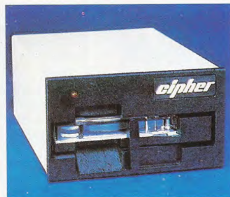
La fotografía muestra una unidad de cartucho de 20 Mbytes de capacidad. La cinta que emplea es de 5 1/4", según la normalización internacional ANSI. La unidad, de la firma CIPHER, trabaja con una densidad de almacenamiento de 6.400 bits por pulgada (bpi).
