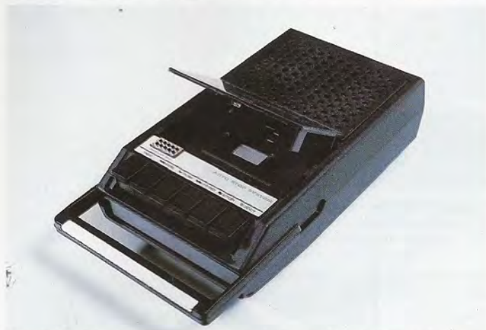
Uno de los sistemas de almacenamiento de datos más populares es la cassette convencional de audio, que se adapta a las exigencias de los microordenadores domésticos. La mayor ventaja de estos sistemas es su bajo coste, lo que permite una mayor difusión de los programas en un soporte estándar.
