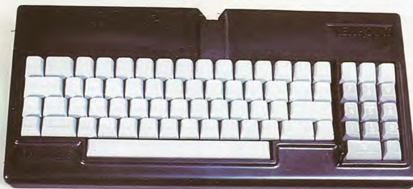
El teclado está formado normalmente por un bloque de teclas alfanuméricas y un bloque de teclas decimales que facilitan la introducción de datos numéricos. Algunos teclados incorporan, además, una serie de teclas a las que pueden asignarse funciones especiales.
