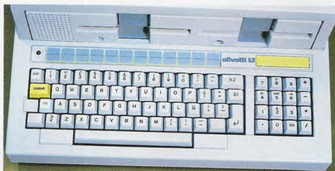
El teclado del OLIVETTI M-20 es de tipo QWERTY, con un total de 72 teclas distribuidas en dos zonas: teclado alfanumérico y «keypad» de teclas numéricas.
