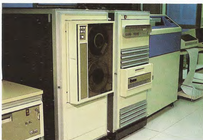
Las unidades de bobina no tienen razón de ser en sistemas pequeños, ya que su fiabilidad y flexibilidad se ven notablemente superadas por los sistemas de discos, tanto rígidos como flexibles.
