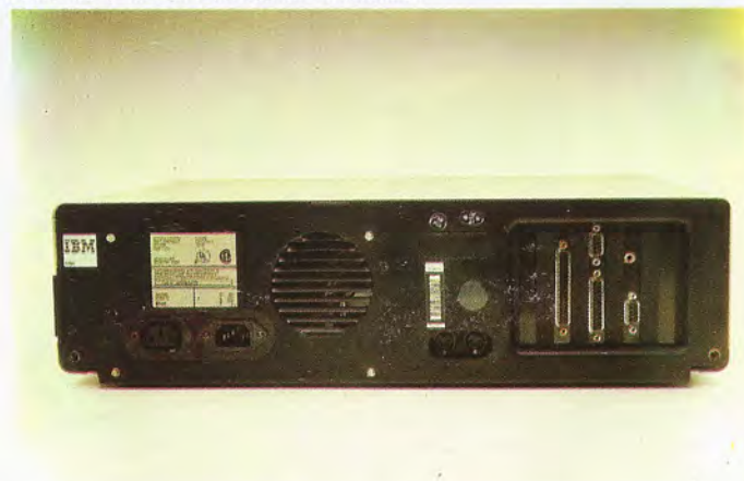
Panel posterior del mueble que aloja a la unidad central del IBM-PC. Además del conector para la toma de alimentación de red, están accesibles los conectores que permiten la expansión del sistema con las oportunas unidades periféricas.
