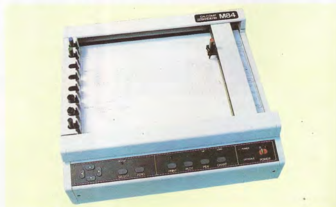
El trazador gráfico o «plotter» es un periférico de salida que traza dibujos sobre papel a partir de la información suministrada por el ordenador.
