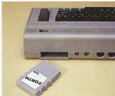
La expansión del equipo básico puede realizarse a través de la conexión directa de módulos funcionales, enchufables a los tres slots de expansión localizados en la zona posterior.
