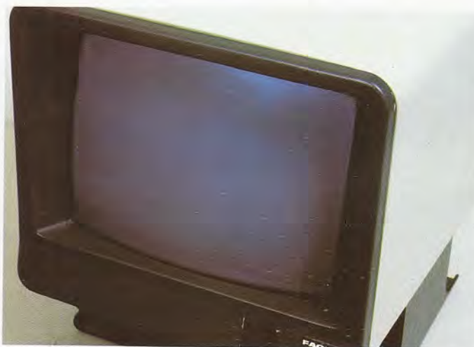
En la pantalla, de fósforo verde, de 12" de diagonal y un área de visualización de 8" x 6", pueden escribirse hasta 24 líneas de 80 caracteres, con una resolución por carácter de 7 x 10 puntos.
