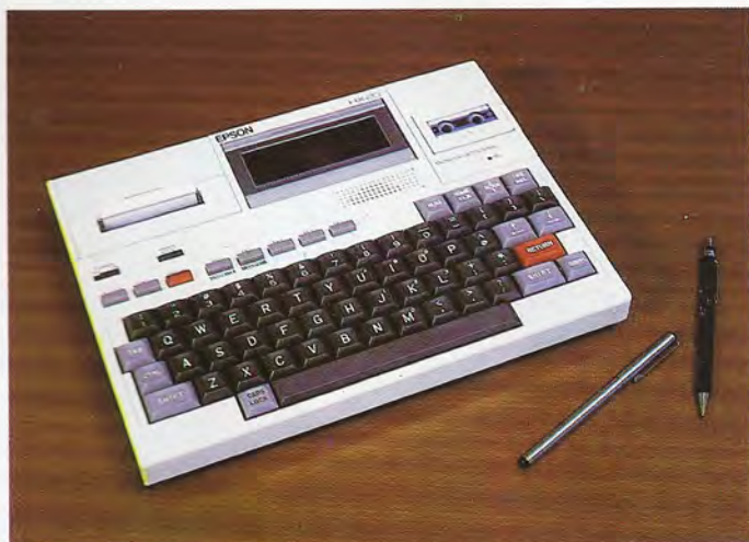
Dentro de la categoría de los microordenadores caben sistemas de muy diversa arquitectura y características. Algunos incorporan en un mismo soporte a la unidad central, el teclado, el órgano de visualización, la memoria de masa e incluso la impresora.
