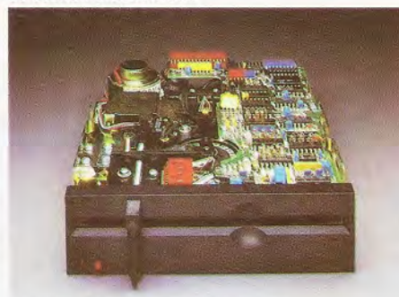
La serie TM848E de discos flexibles de 8 pulgadas se compone de dos modelos: uno de ellos dispone de una cabeza lectora y el otro de dos. En ambos modelos el motor encargado de la rotación del disco está directamente acoplado al eje, evitándose, de esta forma, el uso de poleas y correas.
