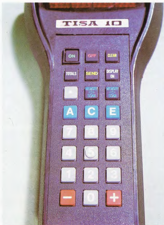
El teclado consta de un total de 24 teclas. Nueve de ellas realizan funciones específicas como enviar datos, visualizar los datos totales o anular un dato provisional.
