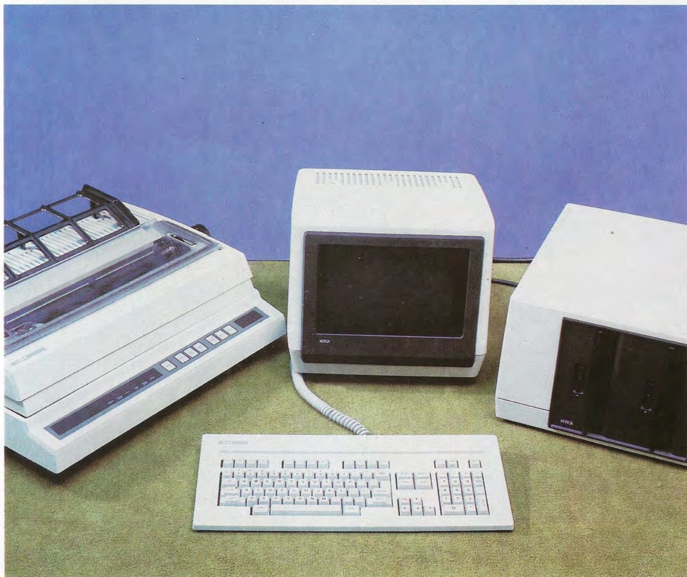
La configuración requerida para el desarrollo de esta aplicación se compone de un ordenador Xerox 820, una unidad lectora de discos flexibles de ocho pulgadas y una impresora. Los programas de la aplicación están grabados en dos discos diferentes, A y B.
