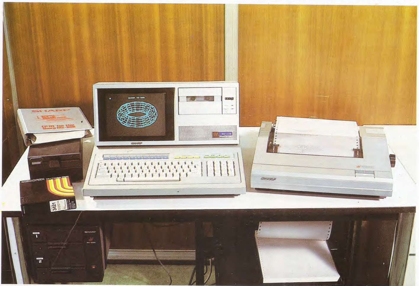
Los ordenadores Sharp MZ-80A y MZ-80B integran en un solo bloque la pantalla, la unidad central y la unidad de cinta de casete. Ambos modelos son de gran utilidad en aplicaciones tanto domésticas, como de gestión.
