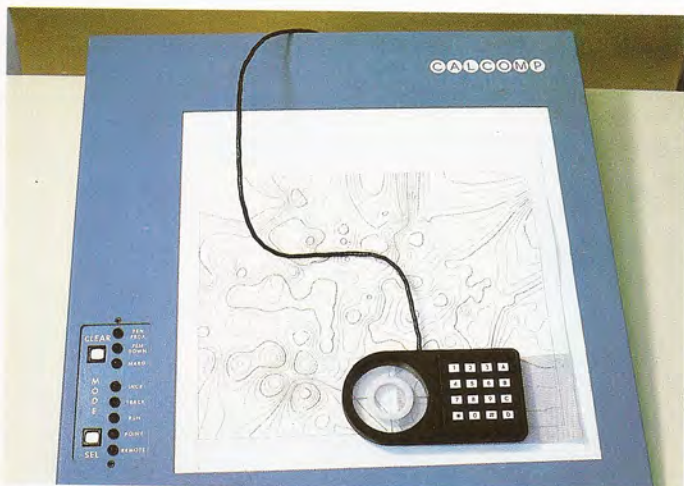
Cualquier punto del tablero de un digitalizador está definido por dos valores: coordenada X, y coordenada Y. Cuando el cursor está activado envía al ordenador los valores de estas dos coordenadas.
