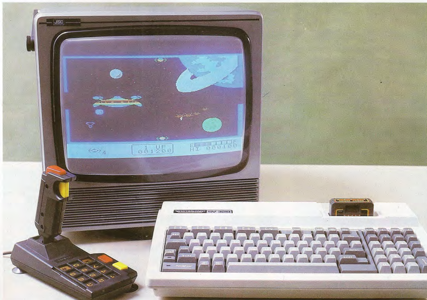
La unidad de central de ambos modelos está alojada en la misma caja que el teclado. Ambos pueden ser conectados a un monitor de vídeo monócromo, o a una televisión de color.
