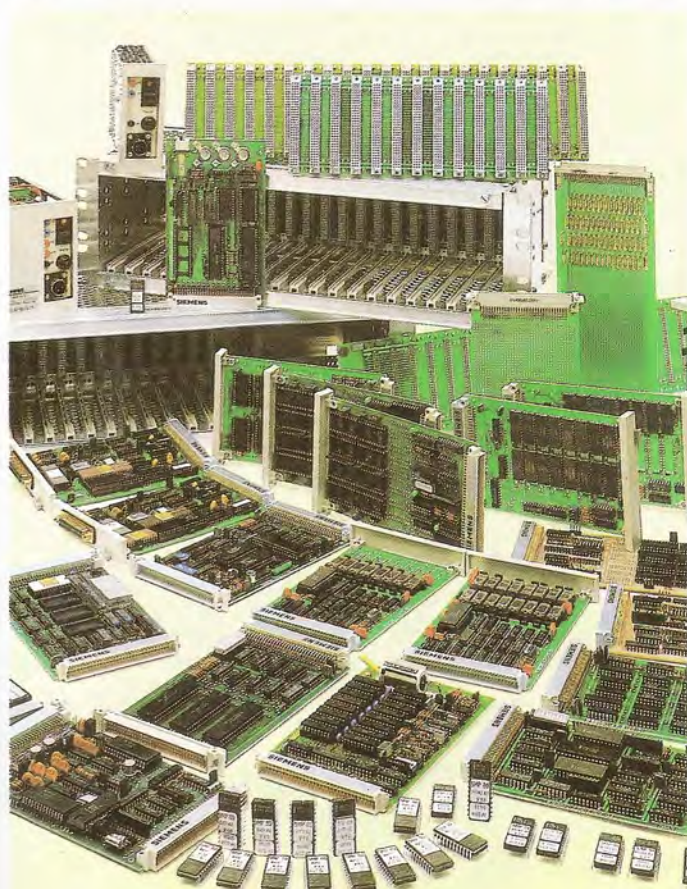
Muchas tarjetas de interface industrial están concebidas para sistemas de control basados en microprocesador. Para facilitar su compatibilidad con el mayor número posible de sistemas, suelen disponer de buses con distribución de líneas normalizada.
