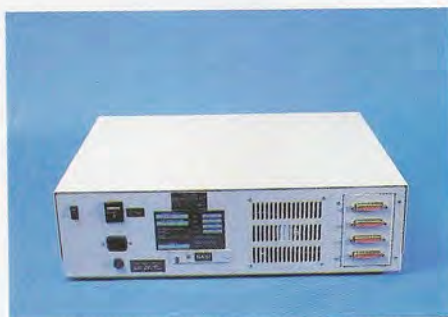
En la parte posterior de la caja que aloja a la unidad central se encuentran los conectores de comunicación y dos interruptores, uno de ellos para el encendido de la unidad y el otro para la carga del sistema operativo.
