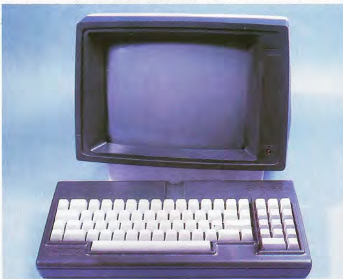
El terminal Adss Viewpoint se compone de un monitor de vídeo de fósforo verde y de un teclado. Tiene dos accesos de comunicaciones: uno bidireccional para la conexión del ordenador central y otro unidireccional para transmisión de datos a una impresora.
