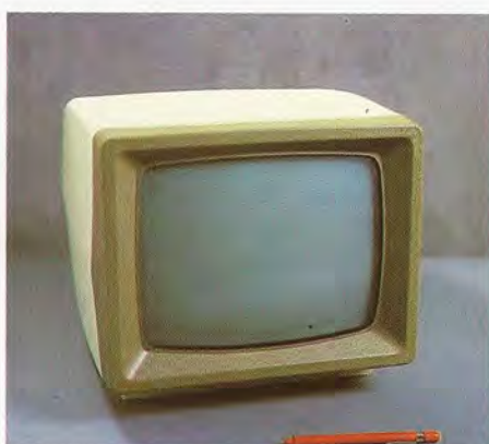
El monitor que se ofrece en la versión básica del C-10 es monocromático de fósforo verde, con 12" de diagonal y alta resolución. La versión básica de este modelo dispone de dos páginas de RAM de video.
