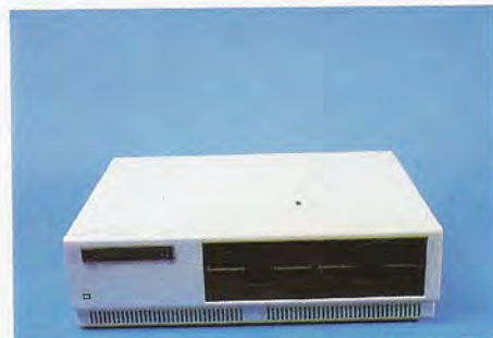
La unidad central y las dos unidades de disco que soporta el sistema se alojan en la misma caja. En el modelo 15 las dos unidades son para discos flexibles, mientras que en los restantes modelos una de las unidades es de disco rígido.
