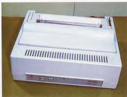
La impresora PR 1450, de Olivetti, trabaja a una velocidad de 100 caracteres por segundo, empleando la técnica de impresión por impacto.
