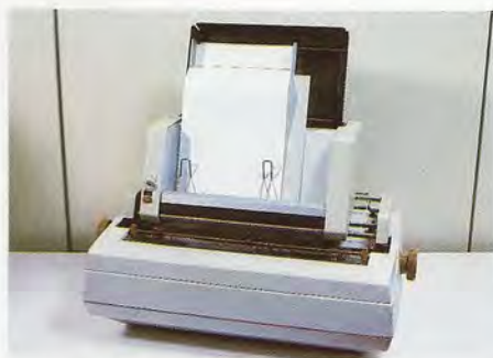
La conexión de cualquiera de los cuatro modelos de impresoras que ofrece el fabricante se realiza directamente, a través de un interface estándar RS/232-C.
