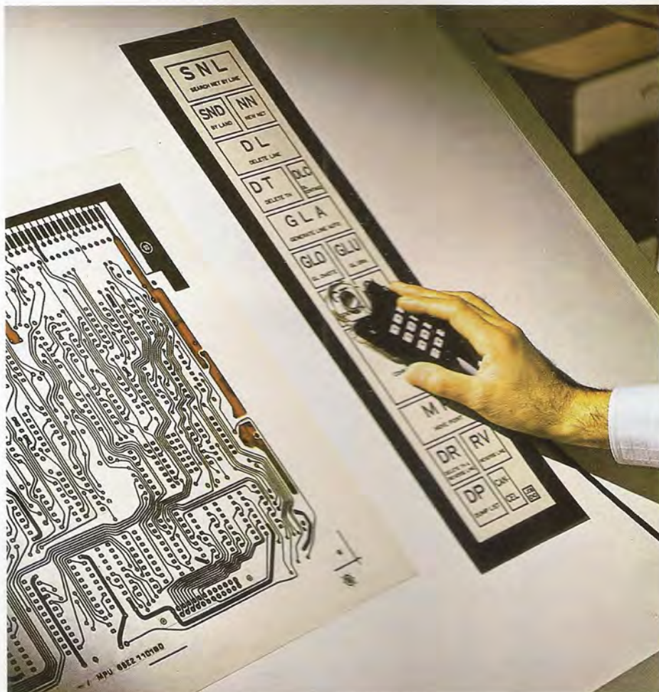
El digitalizador envía los datos al ordenador de cuatro formas distintas: por puntos, por líneas, en forma de datos continuos o en modo incremental. Para seleccionar cualquiera de ellas suelen incorporar paneles de control.
