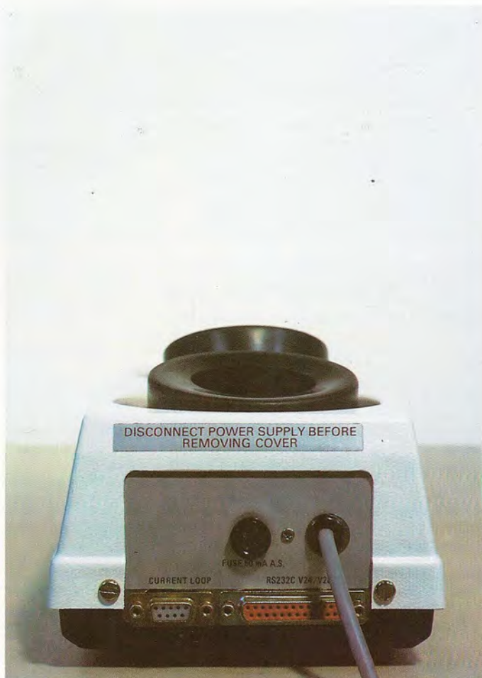
Los conectores para comunicación exterior están situados en el panel posterior de la carcasa de material plástico. Los interfaces son el V24 (conector de 25 patillas) o el estándar «bucle de 20 mA» (conector de 9 patillas).
