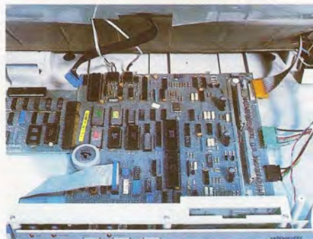
Cuando la máquina está desconectada de la red, una batería tampón se encarga de alimentar a la memoria RAM en la que se almacenan todas las características de impresión previamente programadas.
