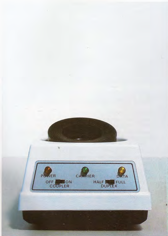
Panel frontal común a los acopladores acústicos de la serie KN-800. Posee dos conmutadores (conexión y selección half/full duplex) y tres indicadores a LEDs.
