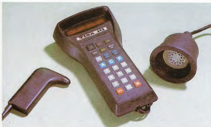
El Tisa 10 es un terminal portátil inteligente para colecta y transmisión de datos a un ordenador central. Para realizar estas funciones dispone de un acoplador acústico telefónico y de un lector de código de barras independiente.
