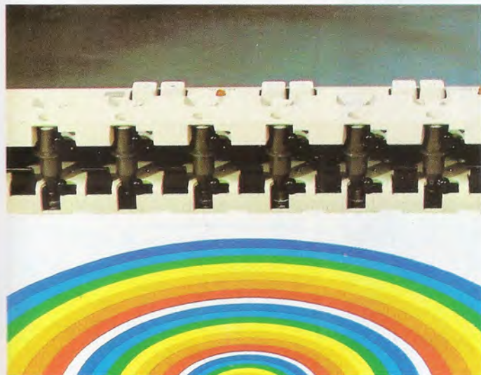
Plumas de impresión del plotter HP 7220. Sus ocho plumas admiten seis anchos distintos de línea.
