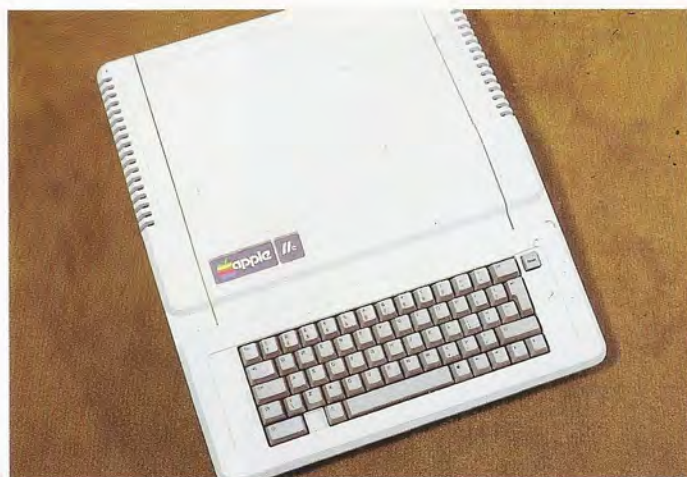
La unidad central y el teclado están alojados en la misma carcasa, color beige, de reducidas dimensiones y poco peso.
