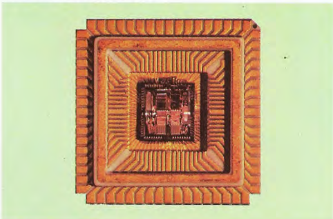
Unidad central de proceso de un ordenador de 32 bits. Con los microprocesadores actuales no se alcanza, aún, la potencia y velocidad proporcionadas por una CPU de este tipo.
