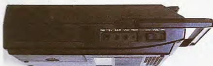
El equipo admite la conexión directa y simultánea de dos unidades para cassettes de audio; pueden ser magnetófonos de tipo convencional. La incorporación simultánea de ambas facilita la gestión de archivos en cinta.
