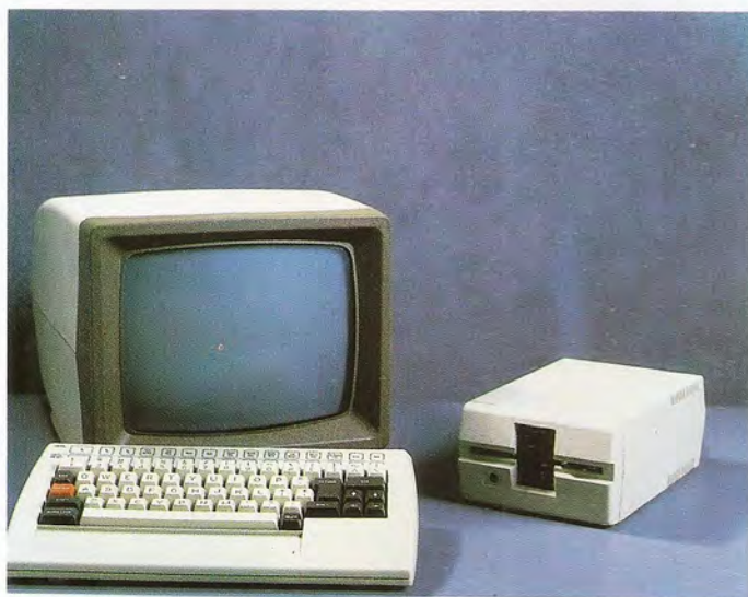
Esta aplicación se desarrolla sobre un sistema de ordenador Cromenco C-10 con unidad central, pantalla, doble unidad de discos de 5,25 pulgadas e impresora.
