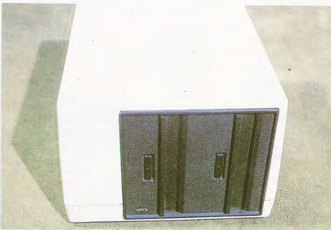
La versión básica incorpora dos unidades de disco flexible de 5 y 1/4 o de 8". Es posible reemplazar una de estas unidades por una unidad de disco rígido de tecnología Winchester.
