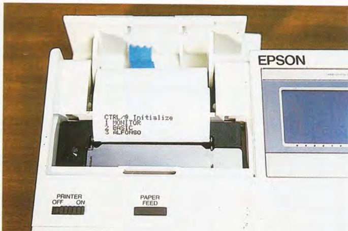
La versión básica de este equipo incorpora una microimpresora controlada por dos mandos específicos: PRINTER ON/OFF para la conexión de la unidad, y PAPER FEED, que hace avanzar el papel.
