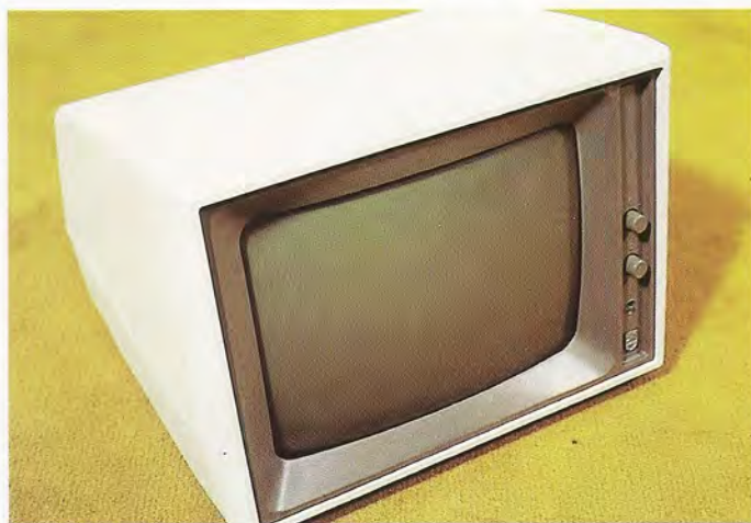
El monitor de vídeo de la versión básica es un PCT 1201, monocromático. El formato de presentación en pantalla es de 24 filas por 40 columnas, ampliables a 80 columnas mediante una tarjeta de expansión.
