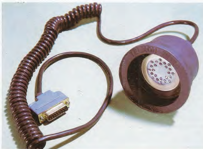
El acoplador acústico se conecta al auricular del teléfono, permitiendo así la transmisión directa de los datos almacenados en el terminal al ordenador central.
