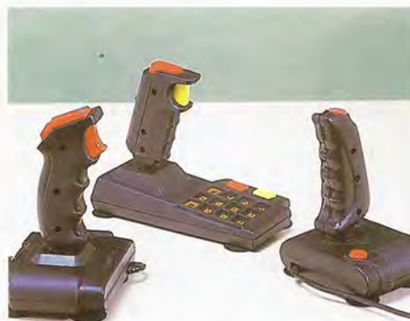
Spectravideo ofrece tres modelos distintos de joysticks, adaptables por estos ordenadores. Tienen la particularidad de fijarse firmemente a las superficies planas por medio de cuatro ventosas de caucho colocadas en su parte inferior.
