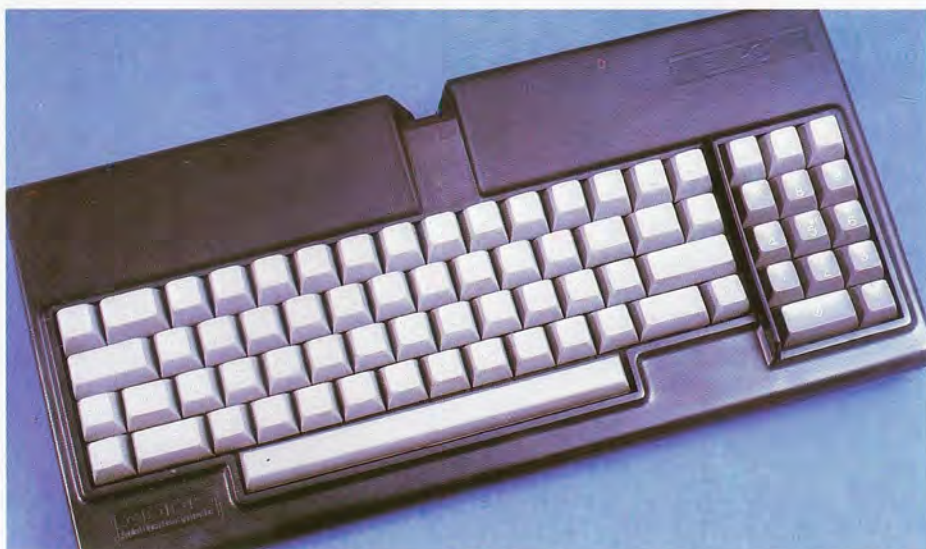
El teclado incorpora 72 teclas, dispuestas en dos zonas separadas. La primera, incorpora las teclas alfanuméricas; la otra, comprende las teclas numéricas, las del movimiento del cursor y cuatro para funciones específicas.
