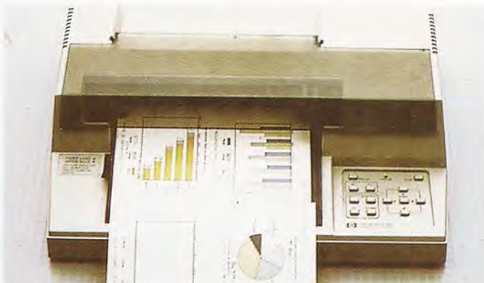
El plotter HP-7470 incluye dos plumillas de dibujo. Realiza gráficos con un formato DIN-A4 y una resolución de 0,025 mm.
