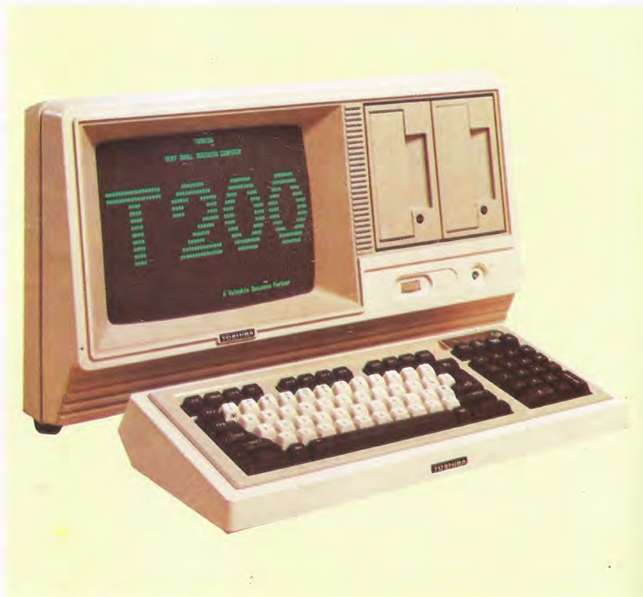
Esta aplicación ha sido diseñada para un sistema Toshiba T-200 dotado de impresora y de doble unidad de discos flexibles.
