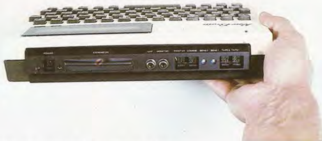
En la zona posterior del mueble que aloja a la unidad central se encuentran los conectores para la comunicación con dispositivos periféricos y memorias de masa.
