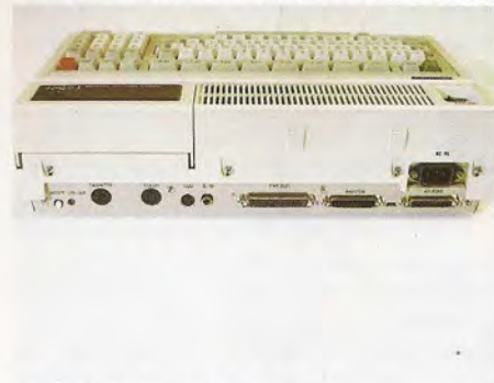
En el panel posterior del mueble están situados los conectores para la comunicación de la unidad central con dispositivos periféricos.
