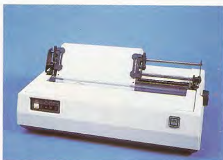
Las cuatro impresoras de la gama son bidireccionales. El número de columnas de impresión varía desde 80 en el modelo 82A, hasta 163 en el modelo RP 16200.
