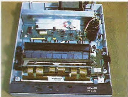
Una particularidad muy destacable de este modelo térmico reside en la posibilidad de imprimir en japonés, para lo cual sólo hay que cambiar el generador de caracteres.
