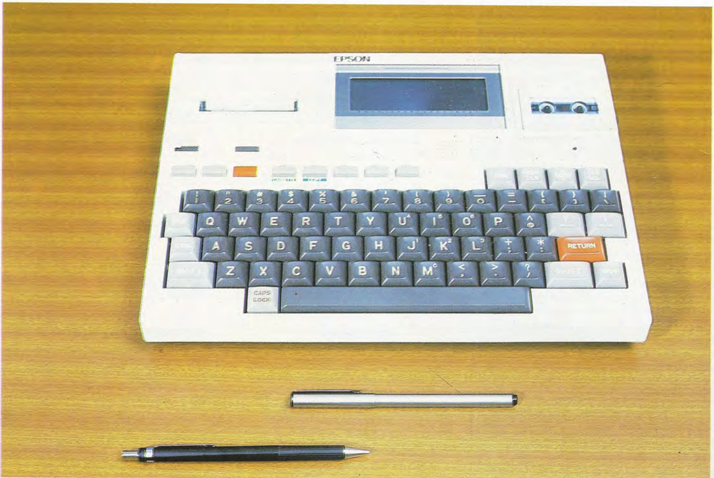
El Epson HX-20 tiene un tamaño algo mayor que el de una calculadora de bolsillo. Es, sin embargo, un ordenador portátil que puede funcionar autónomamente o como terminal de un sistema más potente.
