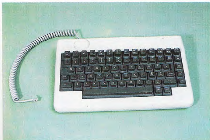
El teclado, del que existe una versión con caracteres propios del español, es de tipo Qwerty, e incorpora diez teclas de función.
