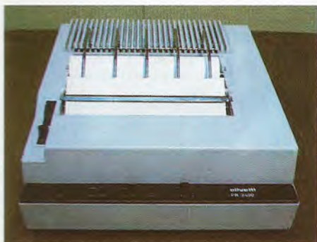
Impresora térmica modelo 2400. Su cabeza consta de 80 electrodos que forman matrices de 7 x 5 puntos e imprimen a razón de 240 líneas, de 80 caracteres, por minuto.
