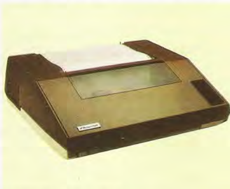
La principal característica de las impresoras de la serie M es su gran rapidez de impresión: en el modelo M-200 la velocidad se eleva a 340 caracteres por segundo.
