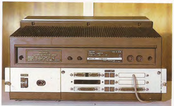
Los conectores de ambos modelos están localizados en la parte posterior del bloque de la unidad central. La conexión con las unidades de discos y con la impresora debe realizarse a través de interfaces opcionales.
