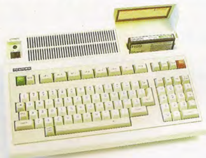
La unidad central del T-100 incorpora 32 Kbytes de ROM, ampliables a 64 Kbytes por medio de un cartucho enchufable al conector localizado en la parte superior derecha del equipo.
