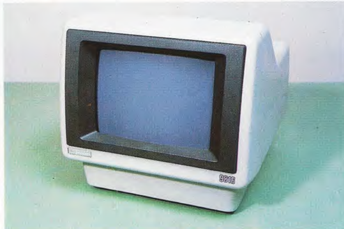
La pantalla, de fósforo gris, tiene una definición gráfica de 300 puntos verticales por 400 horizontales, esto es: 120.000 pixels.
