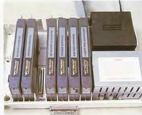
Por medio de un expansor pueden conectarse a estos ordenadores hasta siete periféricos distintos: impresora, modem telefónico, joystick especial para disparo rápido, tableta digitalizadora, doble unidad de disco flexible y casete de audio, entre otros.
