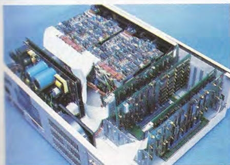
El microprocesador que gobierna el sistema es un 8085 AH2, operando a una frecuencia de 5 Mhz. La zona de memoria RAM, de tecnología MOS, dispone de un circuito de refresco que garantiza la conservación de los datos almacenados.
