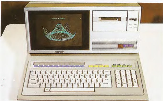
El teclado del modelo A no dispone de teclas para funciones programables por el usuario. Las teclas para el movimiento del cursor están colocadas en la zona alfanumérica.
