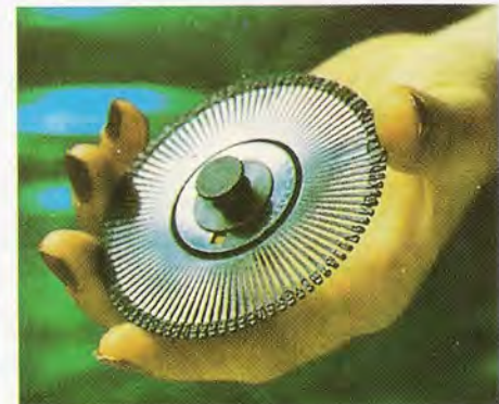
Rueda de caracteres de las impresoras de margarita. Consta de 96 caracteres. La firma dispone de otros modelos de margaritas con 88 y 92 caracteres.
