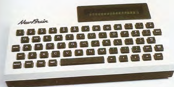
El teclado, de tipo QWERTY y con un total de 62 teclas, está incorporado en la misma caja de la unidad central. El visualizador alfanumérico (opcional) emplazado en la zona superior del mueble facilita la operación autónoma del equipo básico.
