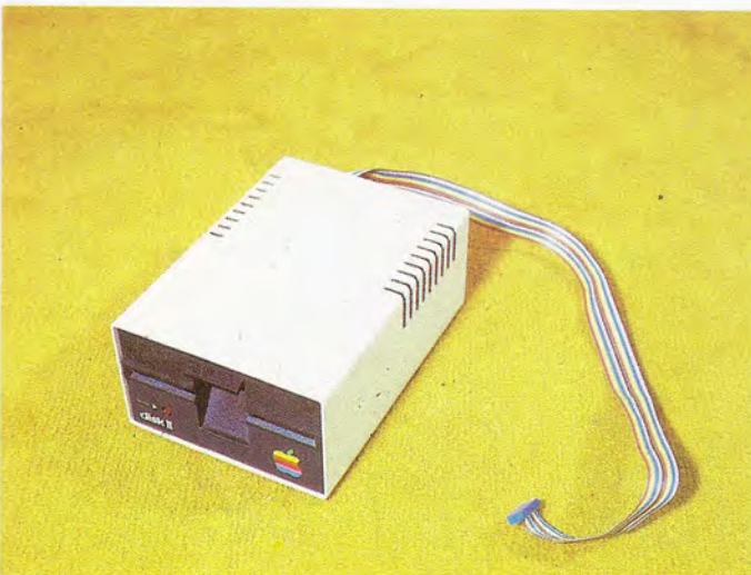
Aunque la versión básica va provista de una salida para conexión con casete de audio, el sistema puede gestionar hasta seis unidades dobles de disco, con una capacidad de 140 Kbytes cada una de ellas.
