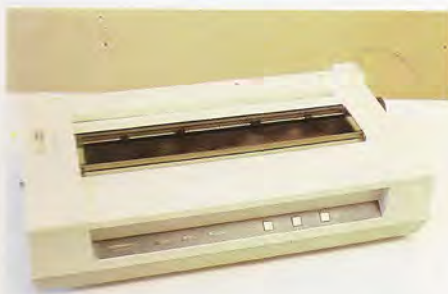
El modelo PA 7252 mejora las posibilidades de las restantes impresoras de la gama Toshiba, imprimiendo hasta 136 caracteres por línea.
