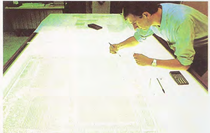
Antes de pasar al proceso de grabación se verifica la distribución de los componentes sobre una reproducción de la máscara ampliada quinientas o más veces.
