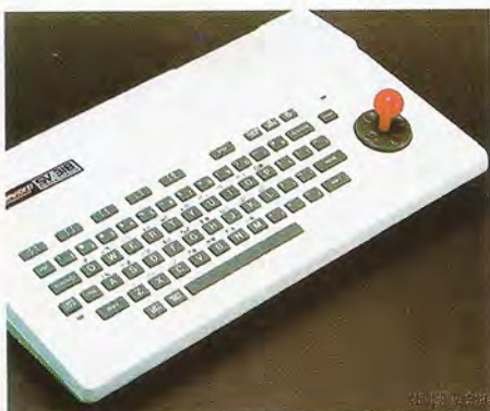
Las teclas del SV 318 son de goma. Una palanca de joysticks incorporada permite el movimiento del cursor dentro de la pantalla en ocho direcciones.
