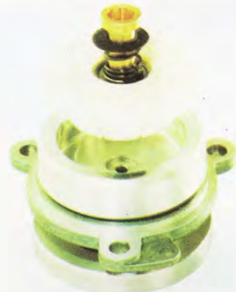
El motor que hace girar al disco lleva un control de velocidad de gran precisión, que se pone en marcha al introducir el disco dentro de la unidad.
