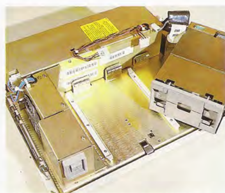
Una de las características más destacables del sistema es su alto nivel de modularidad: la fuente de alimentación, la tarjeta de la CPU y las unidades de disco se pueden desmontar y cambiar con suma rapidez y comodidad.
