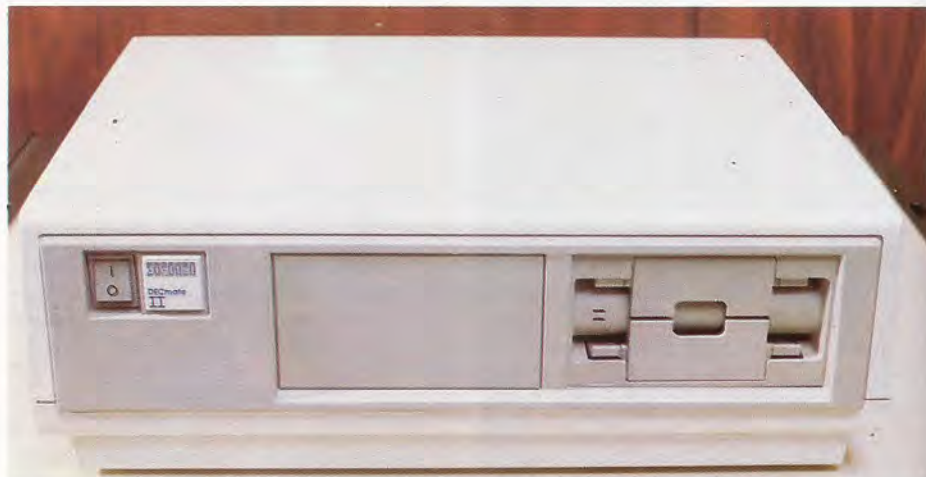
La configuración básica dispone de una unidad dual de discos flexibles. De forma muy sencilla puede acoplarse una segunda unidad de disco flexible y una unidad de disco rígido de tecnología Winchester.
