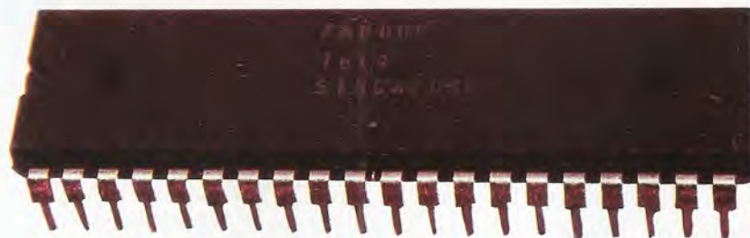
El microprocesador 6800, una vez encapsulado. El aspecto exterior de este potente microprocesador de 16 bits es similar al de cualquier otro circuito integrado con 40 espines.
