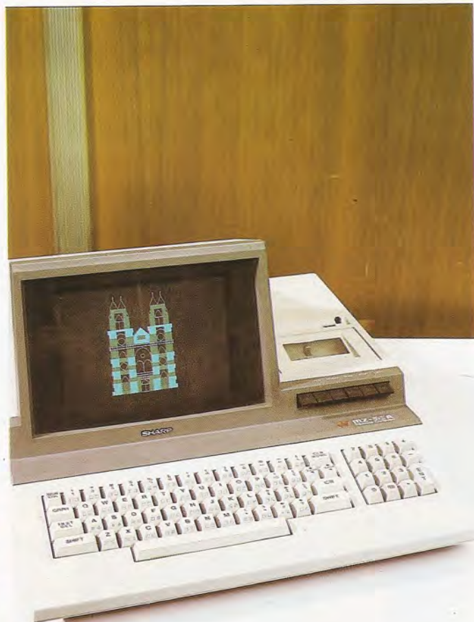
El teclado del MZ-80B consta de un total de 92 distribuidas en un teclado alfanumérico, un grupo de cuatro teclas (verdes) para el control de casete, otras cuatro teclas (naranjas) para el movimiento del cursor y un grupo de diez teclas (azules) para funciones programables por el usuario.
