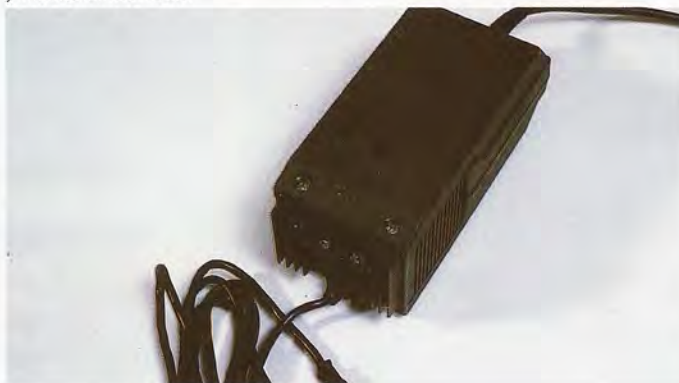
La alimentación del New Brain se obtiene a partir de un módulo exterior conectable a la red de distribución eléctrica. Este módulo suministra la tensión continua necesaria para el funcionamiento del equipo.
