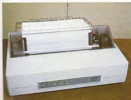
La impresora 1471 utiliza la técnica de impresión por impacto. Con papel autocopiativo puede proporcionar hasta cuatro copias por original. Su velocidad de impresión es de 140 caracteres por segundo.
