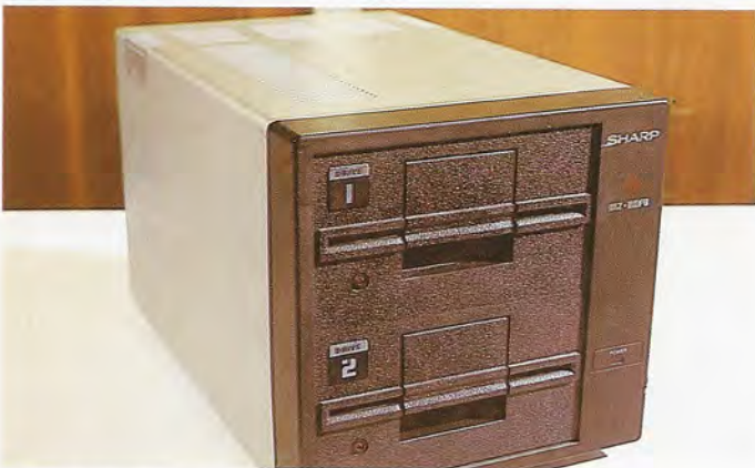
Los dos modelos pueden gestionar hasta cuatro unidades de disco flexible. Cada unidad incorpora dos discos de doble cara y doble densidad de 5 1/4", con una capacidad por disco formateado de hasta 320 Kbytes.
