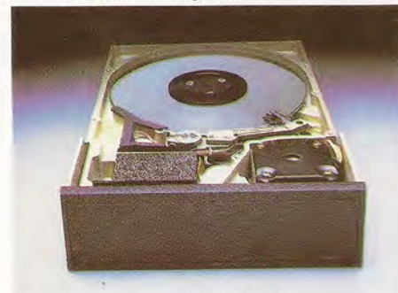
La familia de discos rígidos TM250 consta de dos unidades. Ambas incorporan dos discos rígidos por unidad, si bien varían las capacidades de almacenamiento: 6,4 Mbytes en el primer modelo y 12,8 Mbytes en el segundo.
