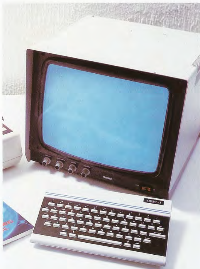
El teclado consta de 57 teclas autorrepetitivas, cuatro de ellas, situadas a ambos lados de la barra espaciadora, para el movimiento del cursor.
