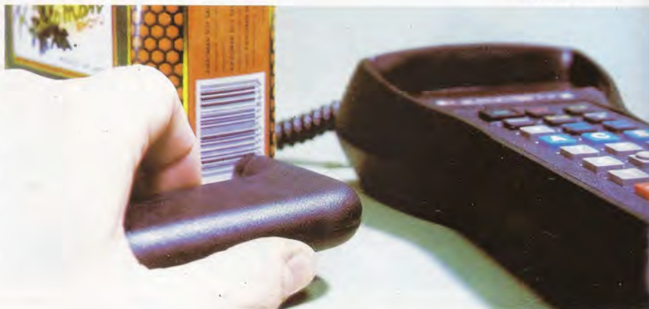
El lápiz óptico lee los datos escritos en código de barras y los almacena directamente en la memoria del terminal.
