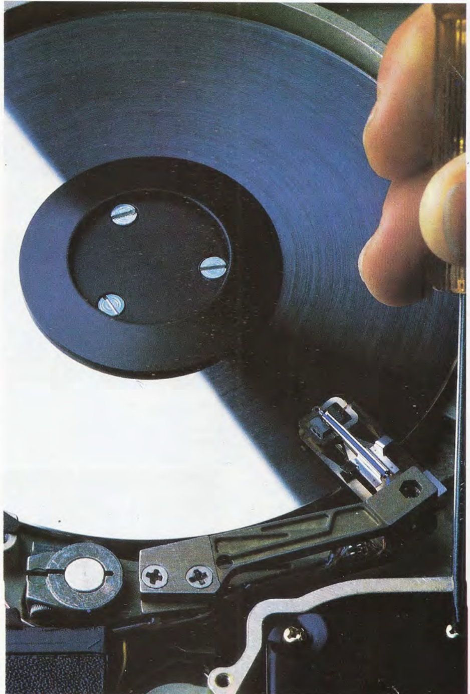
Detalle de la cabeza lectora de una unidad de disco rígido. La vida media de los componentes de este tipo de unidades de disco es de cinco años.
