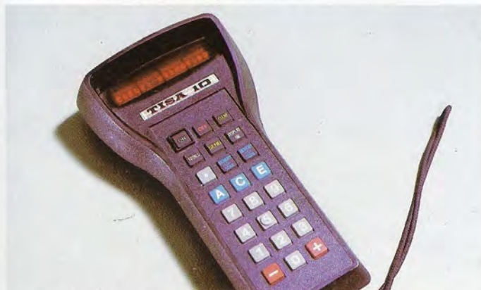
El terminal es un pequeño ordenador portátil, alimentado por pilas, que se conecta al ordenador central, a través de la línea telefónica, al que transmite los datos memorizados.
