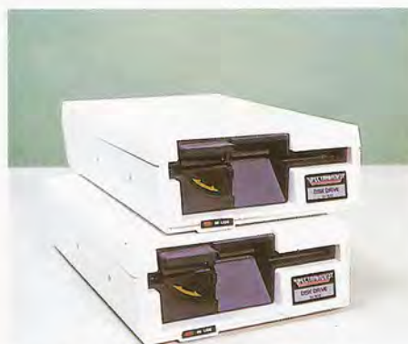
Las unidades de disquetes diseñadas para estos equipos admiten discos flexibles de 5,25 pulgadas con una capacidad total de 256 Kbytes cada una de ellas. Su incorporación al modelo SV 328 permite trabajar con el sistema operativo CP/M.
