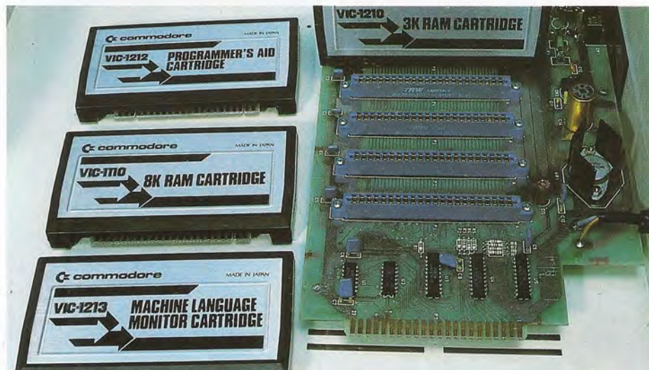
Las memorias de casi todos los sistemas informáticos presentes en el mercado admiten ampliaciones por medio de módulos de expansión como los de la figura.
