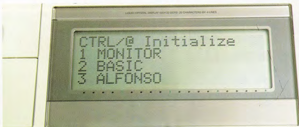
La pantalla de visualización es de cristal líquido y consta de cuatro líneas de veinte caracteres cada una.
