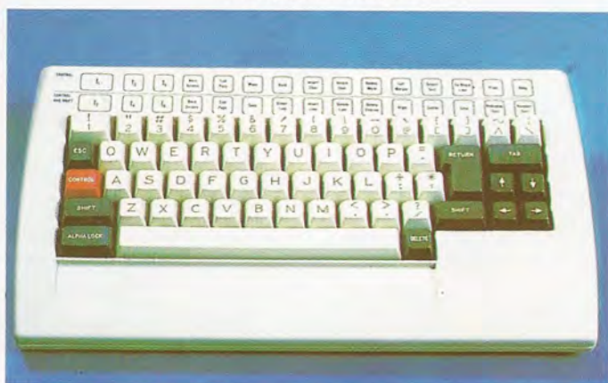
El teclado —independiente de la unidad central— es de tipo QWERTY, con 60 teclas. Posee cuatro teclas para movimiento de cursor, click audible y repetición automática ajustable.
