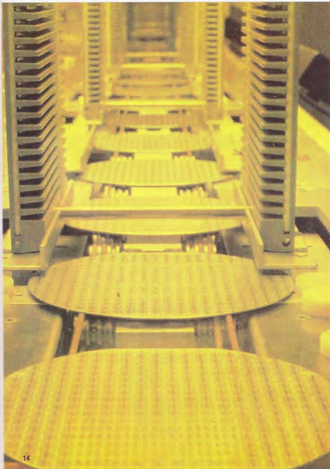
Durante la fase de fotograbado, una simple mota de polvo depositada sobre la oblea del material semiconductor, puede llegar a estropear alguno de los circuitos. Esta fase se realiza en unas condiciones ambientales muy cuidadas.
