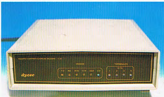
Los sistemas de multipunto permiten la conexión de una entrada con diferentes salidas. El modelo ECM-81 permite la conexión de un modem con cuatro terminales locales.
