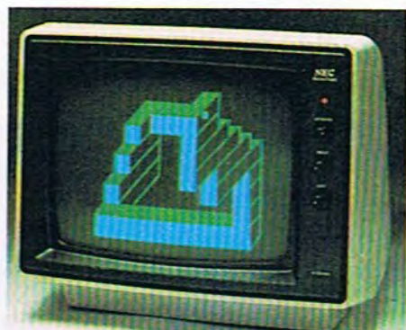
El modelo JB 1201 ME-1 está provisto de pantalla de fósforo verde y el modelo JB 1205 M(E) tiene pantalla de fósforo ámbar. Ambos modelos son monitores con diagonal de 12", entrada de video compuesto, incorporando amplificador de audio y altavoz.
