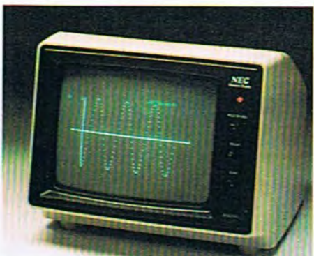
El modelo JB 902 ME-1 es una unidad de 9" de diagonal con imagen en fósforo verde que admite hasta 25 líneas de 80 caracteres. El monitor está provisto de amplificador y altavoz.
