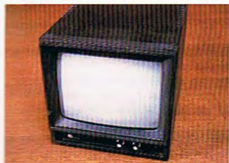
El MPF-2 puede trabajar indistintamente con un monitor o con un receptor de TV, existiendo tres modos de visualización: uno para texto y dos para gráficos.
