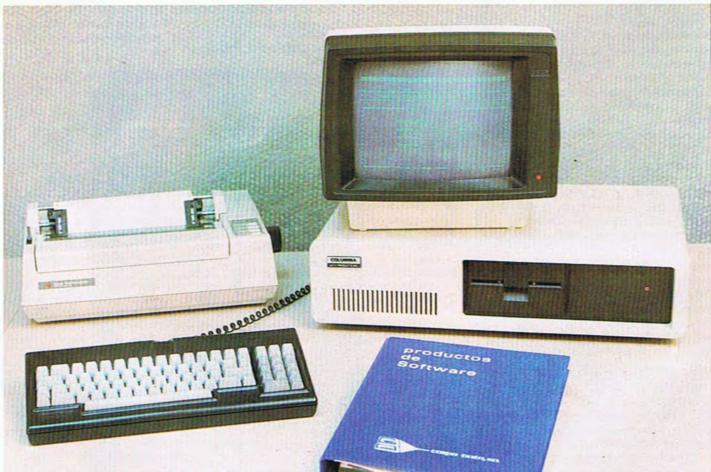
La gama de ordenadores COLUMBIA 1600 está compuesta por tres sistemas distintos, que permiten cubrir ampliamente las necesidades de los posibles usuarios. Los modelos 1601 y 1604 son de sobremesa, siendo monousuario el primero y multiusuario el segundo. Ambos modelos son de igual aspecto físico externo.
