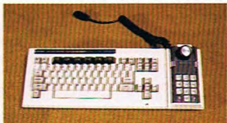
El teclado está compuesto por un total de 75 teclas en disposición QWERTY. Es independiente de la Unidad Central, a la que va unido mediante un cable helicoidal. Uno de los paddles de que dispone el equipo puede ser situado sobre un soporte especial y unido al teclado para emplearse como teclado numérico de trabajo.
