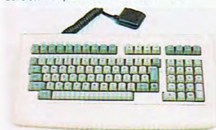
El teclado es de tipo QWERTY y está conectado a la unidad central mediante un cable en espiral. En total el teclado consta de 99 teclas agrupadas en 5 grupos: teclado alfanumérico, teclas de formateo, teclas de edición, teclas de función y teclado numérico.
