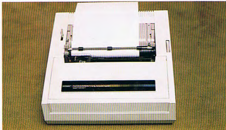
La configuración básica incorpora una impresora de margarita de alta calidad con método de impresión bidireccional, arrastre por tractor para papel continuo o por fricción para hojas sueltas. La velocidad de impresión es de 120 caracteres por minuto.
