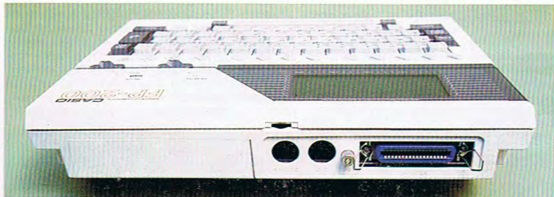
En la parte posterior del equipo se encuentran las conexiones para magnetófono, interface paralelo e interface serie.
