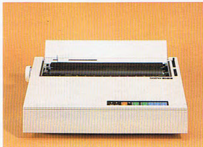
La impresora Brother, modelo HR-15 es una impresora de margarita, con una velocidad de impresión de 13 c.p.s. un ancho de carro de 340 mm. y tracción por fricción.
