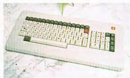
El teclado de perfil bajo consta de 91 teclas agrupadas en dos conjuntos: a la izquierda, un teclado clásico de máquina de escribir tipo QWERTY, más diversas teclas de función, compuesto por un total de 73 teclas, y, a la derecha, un keypad numérico, más cinco teclas para el control del cursor.
