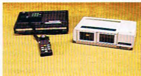
La Unidad Central de Proceso está basada en el microprocesador Z80A de 8 bits. Su memoria RAM, incluidas las ampliaciones, se eleva a 144 Kbytes. Asimismo, cuenta con un drive de cinta de casete que le proporciona una capacidad total de 506 Kbytes.
