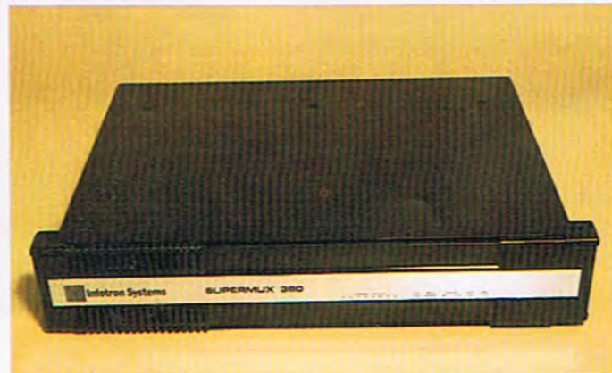
Los multiplexores permiten conectar varios terminales a un mismo ordenador, compartiendo una misma línea telefónica. La firma INFOTRON, representada por DYCEC, presenta estos equipos bajo la denominación SUPERMUX.
