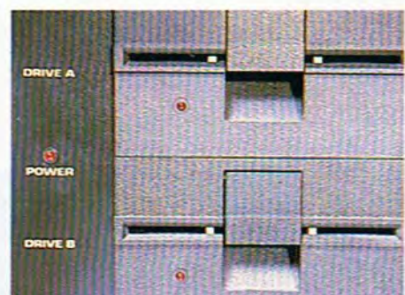
El modelo KAYPRO II cuenta con dos unidades de disco flexible de 5 1/4", con una capacidad de 195 Kbytes por disco. En el modelo KAYPRO 4 los discos son de doble cara y doble densidad, por lo que su capacidad es doble que la anterior.
