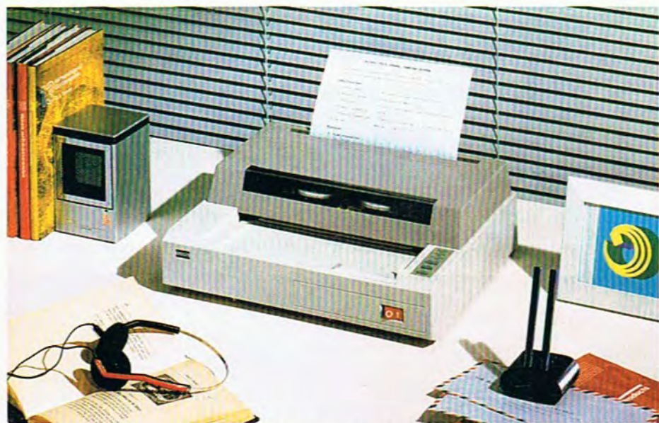
La impresora de la figura es el modelo TP-16 de la firma FUJITSU, y es un ejemplo relevante de impresora que utiliza la transferencia térmica como modo de impresión. La velocidad de impresión es de 54 c.p.s. y puede imprimir incluso sobre película plástica.
