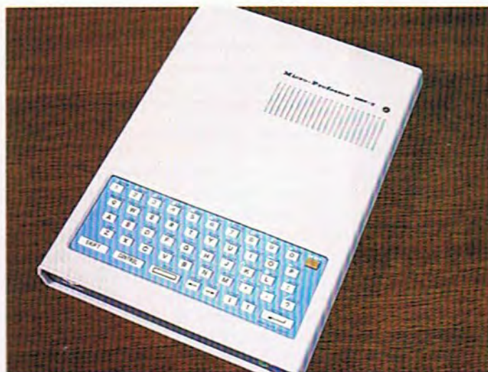
La unidad central es de reducidas dimensiones y dispone, además, de la circuitería propia del ordenador, de un generador de sonidos programable, estando tanto el altavoz como el amplificador integrados en el sistema.
