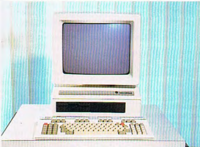
La pantalla es monocromática y tiene 15" de diagonal. En escritura su capacidad es de 25 líneas por 64, 80, ó 132 caracteres, pudiéndose representar gráficos en una matriz de 260 puntos horizontales por 200 verticales.
