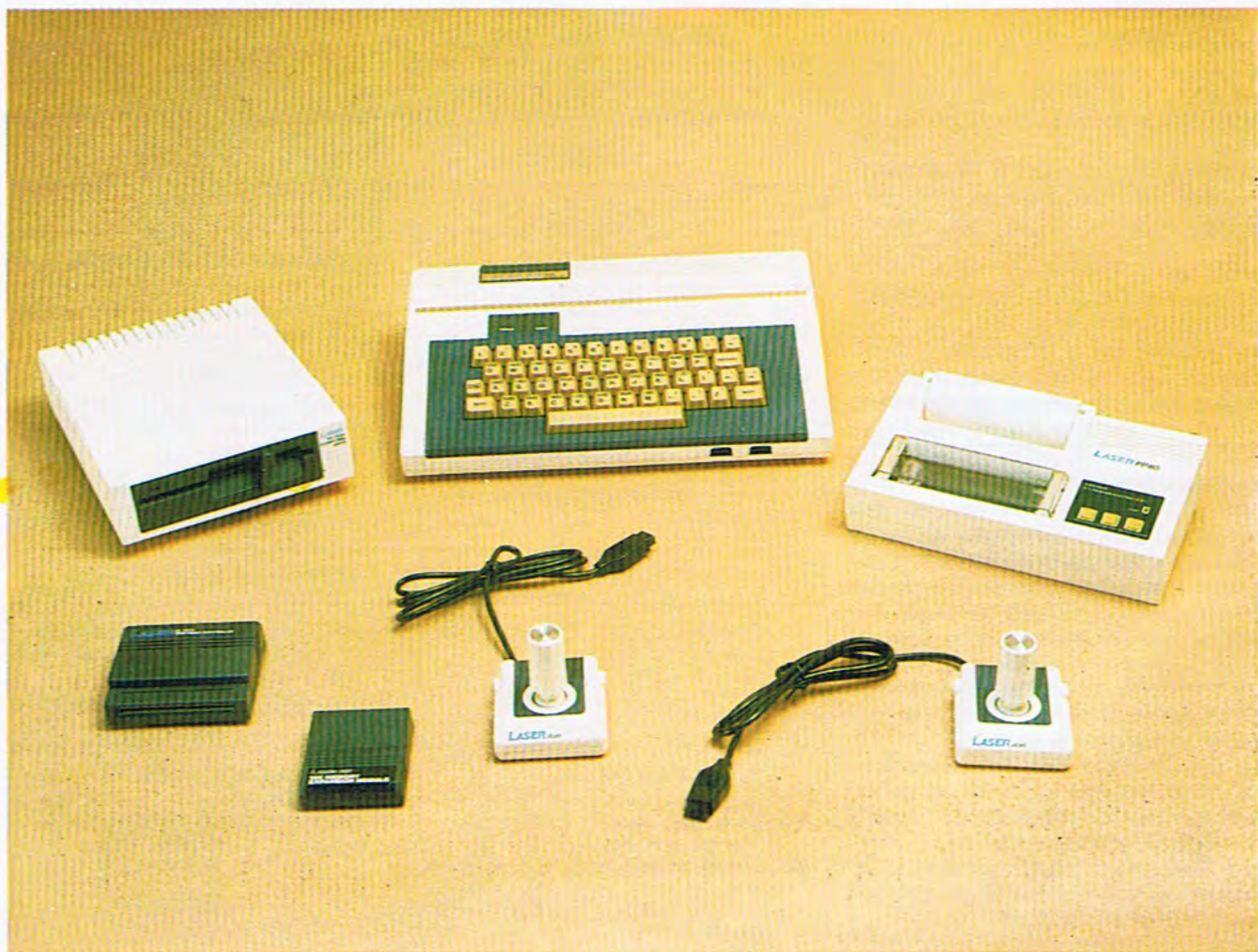
El Láser 2001 es un ordenador personal monousuario orientado principalmente hacia las aplicaciones domésticas, aunque ha sido dotado de periféricos que posibilitan su utilización en aplicaciones de pequeña gestión y técnicas.
