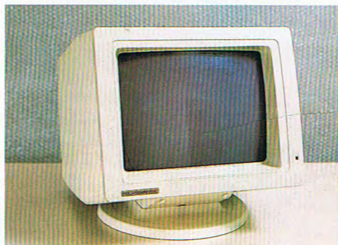
En los modelos 1601 y 1604 puede incorporarse, opcionalmente, un monitor a color; en este caso, se disponen de 16 colores distintos y una capacidad de representación de 25 líneas de 40 u 80 caracteres, y una resolución de 320 x 200 puntos.
