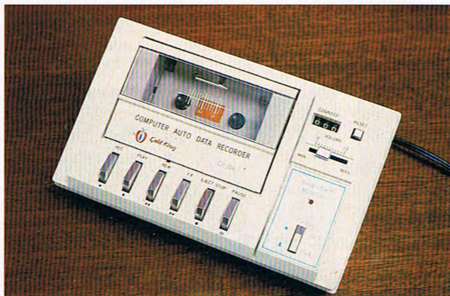
El sistema primario de almacenamiento de datos del MPF-2 es el magnetófono a casete, siendo la velocidad de transmisión de datos de 1.500 baudios. Debido a la estandarización del interface correspondiente se puede conectar prácticamente cualquier modelo comercial de casete.
