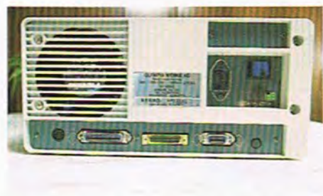
En la parte posterior de la unidad central se encuentran las conexiones del equipo formadas básicamente por: una conexión tipo Centronics, una conexión RS232 y un interface interno para la conexión con las propias unidades de disco. Existe también un slot que soporta diversos tipos de interface.
