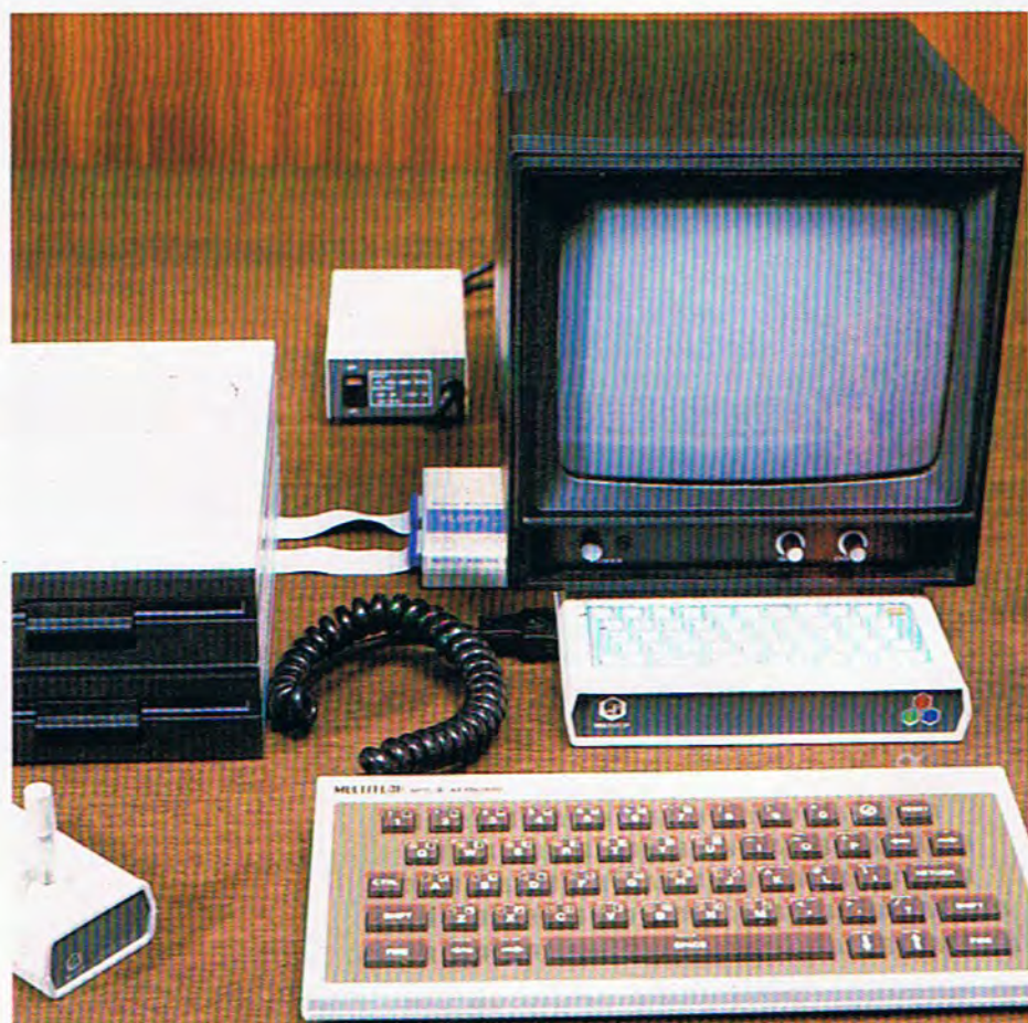
El Micro-Professor II es un equipo compacto que incorpora el teclado en el mismo mueble de la CPU, y que, sin embargo, presenta características técnicas verdaderamente notables, ya que el fabricante ha posibilitado la utilización de un teclado profesional, así como de dos unidades de disco.
