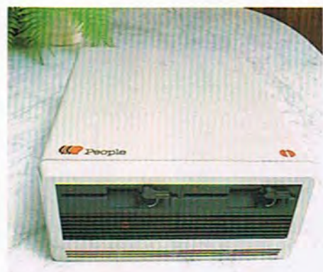
La unidad central es independiente del resto del equipo, y en la versión básica están incluidos dos unidades de disco flexible de 5 \frac{1}{4} .
