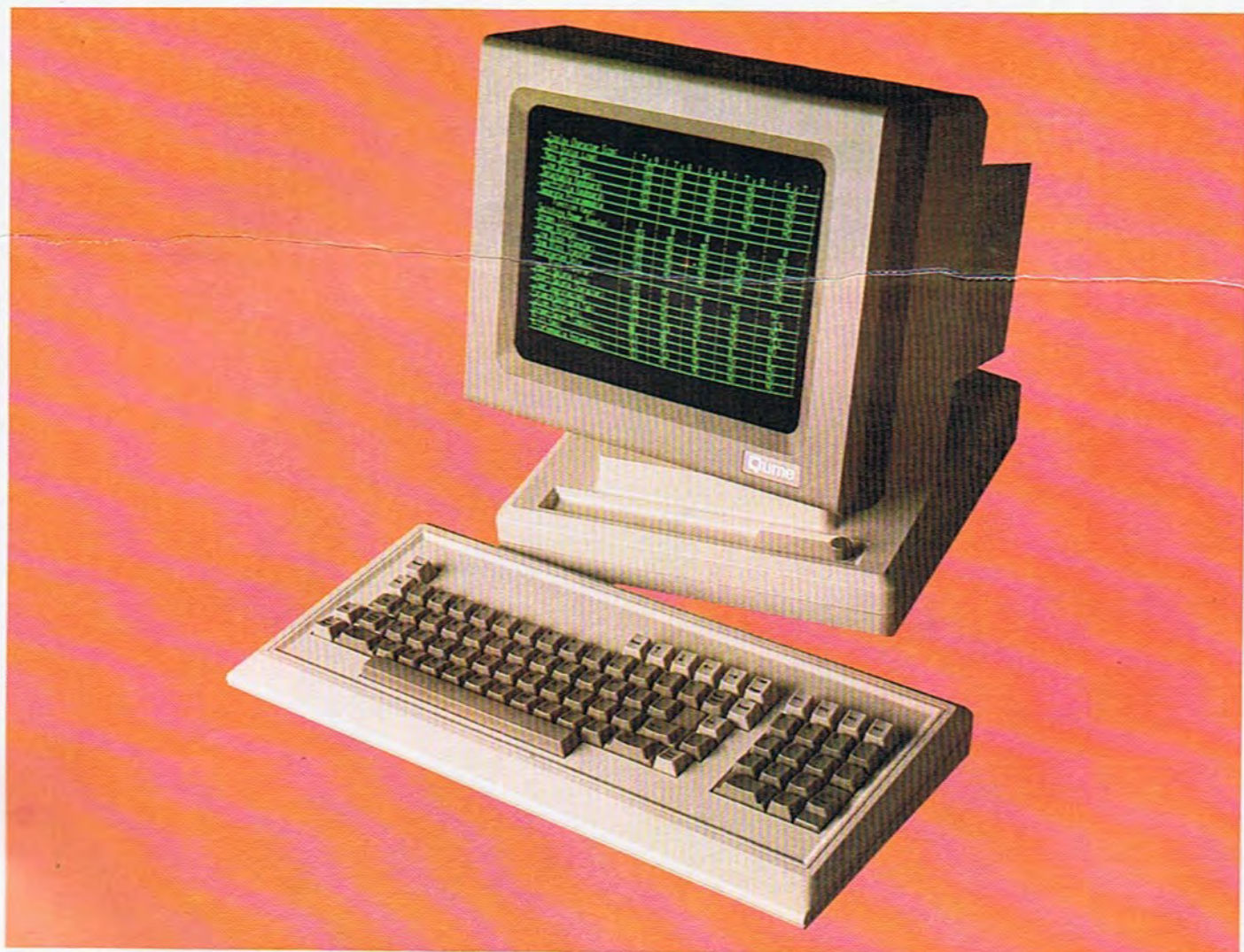
El terminal QVT-102, de la firma Qume, puede emular las especificaciones de otros terminales de mayor precio, mediante una sencilla selección en el menú. El terminal ocupa poco espacio y está diseñado para facilitar el trabajo del operador. Puede elegirse entre verde o ámbar. El formato de pantalla es de 24 líneas de 80 caracteres, existiendo una línea vigésimoquinta para información del operador.
