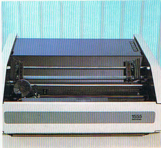
El Sistema 20.0 permite la conexión de varios tipos de impresoras, tanto de interface serie como de interface paralelo, siendo la básica recomendada por el fabricante la Secoinsa modelo 1555. Esta impresora tiene una velocidad de impresión de 185 c.p.s. y cuenta con un juego de 96 caracteres.
