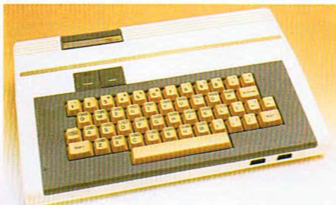
El teclado del Láser 2001 se ha dispuesto sobre el mismo mueble de la unidad central y consta de 49 teclas dispuestas según el tipo QWERTY. Todas las teclas son autorrepetitivas y el juego de caracteres es muy completo. Conviene señalar que las minúsculas se obtienen pulsando la tecla SHIFT en combinación con la tecla que corresponda.
