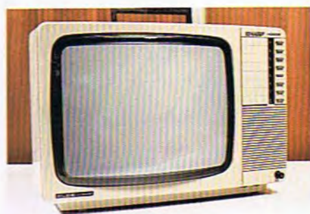
Al igual que la mayoría de los sistemas personales de tipo medio, el SHARP 700 puede conectarse a un receptor doméstico de televisión (B/N o color) en cuya pantalla se visualiza la información, programas, etc. Con pantalla a color se pueden representar hasta ocho colores simultáneamente.
