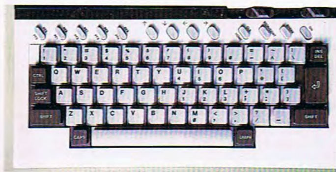
El teclado tipo máquina de escribir consta de 57 teclas móviles con disposición QWERTY. Además de este teclado existen en la parte superior 13 teclas que se utilizan para diversas funciones, así como para el movimiento del cursor.
