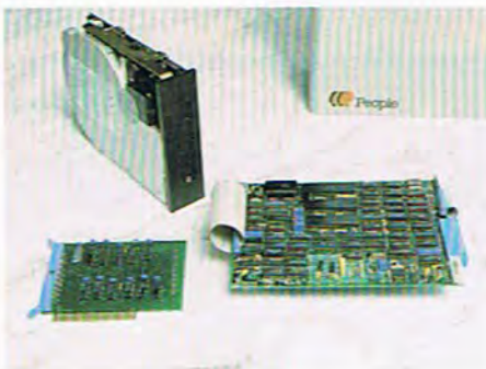
Opcionalmente se puede instalar en el People un módulo de control para una unidad de disco Winchester con 10 Mbytes de capacidad.
