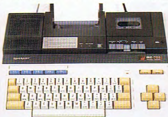
La Unidad Central está basada en el microprocesador de 8 bits Z-80. En el mismo mueble está incorporado también el teclado que adopta la configuración QUERTY, y está formado por 69 teclas, de las cuales cinco sirven para la definición de diez funciones programables.
