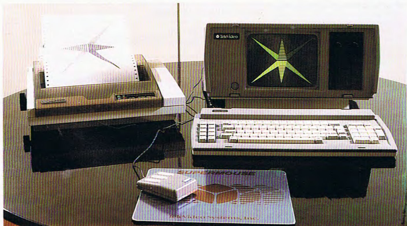
TELEVIDEO SYSTEMS ha decidido desarrollar sus propios sistemas microinformáticos y ha producido una extensa familia de ordenadores compatibles de 8 y 16 bits, dentro de los cuales destaca el modelo portátil denominado TPC-1. En el mismo mueble de la unidad central se alojan una pantalla de 9" y dos unidades de disquete de 5 1/4".
