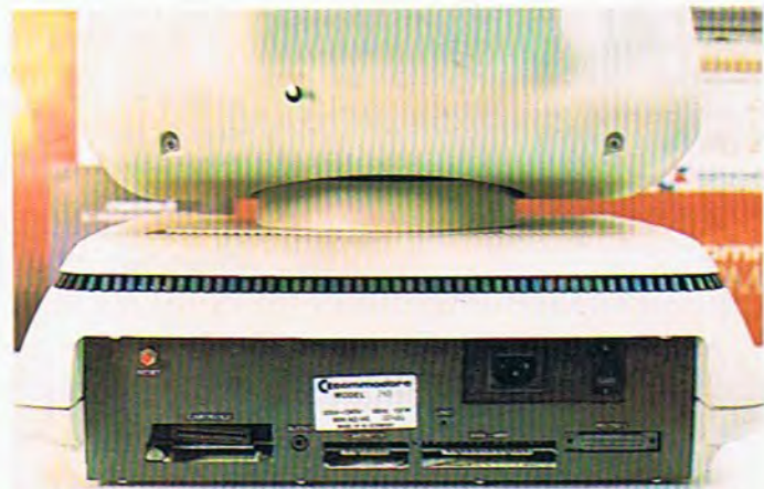
En la parte posterior se encuentran las conexiones del equipo, que constan básicamente de un bus IEEE-488, un interface serie RS-232 C, un acceso paralelo de 8 bits, un acceso para expansión de memoria y una conexión de audio.
