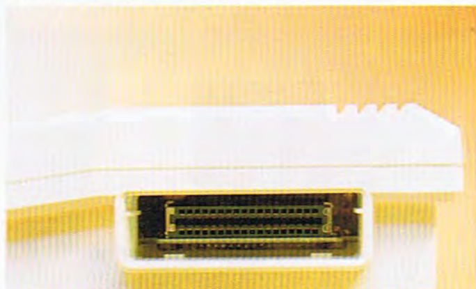
La memoria RAM de la versión básica está constituida por 32 Kbytes, pero puede aumentarse hasta 48 Kbytes si se conecta un módulo de 16 Kbytes en el slot de expansión de memoria situado a la derecha de la unidad central.
