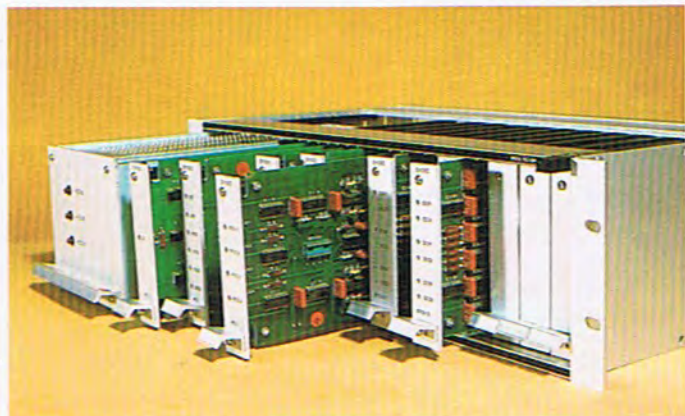
El multipunto modelo ECMP permite la conexión de un modem o puerta de ordenador con cuatro terminales locales y hasta ocho terminales remotos.
