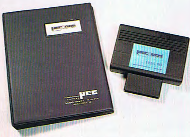
La configuración básica incorpora el sistema operativo KERNAL. Sin embargo, existe como desarrollo propio de MICROELECTRONICA Y CONTROL, distribuidor para España del equipo, el sistema operativo MEC/DOS, que se suministra grabado en un cartucho de memoria ROM.
