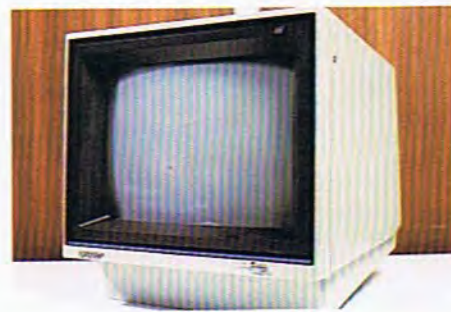
Al igual que la mayoría de los sistemas personales de tipo medio, el SHARP 700 puede conectarse a un receptor doméstico de televisión (B/N o color) en cuya pantalla se visualiza la información, programas, etc. Con pantalla a color se pueden representar hasta ocho colores simultáneamente.
