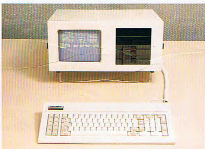
El modelo COLUMBIA VP es un microordenador monousuario cuya principal característica es su portabilidad, estando el monitor incorporado con la CPU en un mismo mueble.
