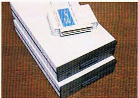
Mediante el interface paralelo de uso general se pueden conectar dos unidades de disco flexible de 5 1/4", con una capacidad por disco de 250 Kbytes.
