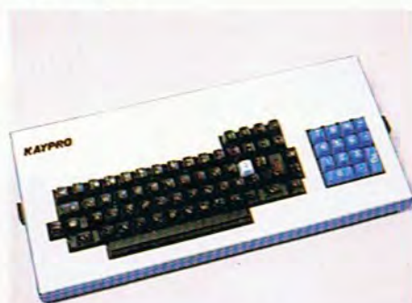
El teclado es independiente de la unidad central, y se conecta a la misma mediante un cable en espiral, contiene un total de 76 teclas, agrupadas en dos bloques y es el mismo para los tres modelos.
