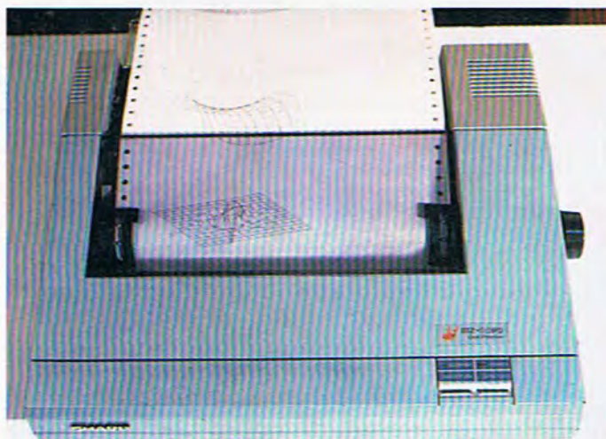
Mediante el interface paralelo se pueden conectar al ordenador diversos tipos de impresora. Pero esta conexión impide la utilización de la pequeña mini-impresora incorporada en el mueble de la Unidad Central.
