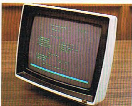
El monitor estándar es monocromático de fósforo verde, siendo la dimensión de su diagonal de 14". Se dispone de una excelente resolución que permite tres formatos de presentación: 25 líneas de 80 columnas, 25 líneas de 132 columnas y 40 líneas de 132 columnas.
