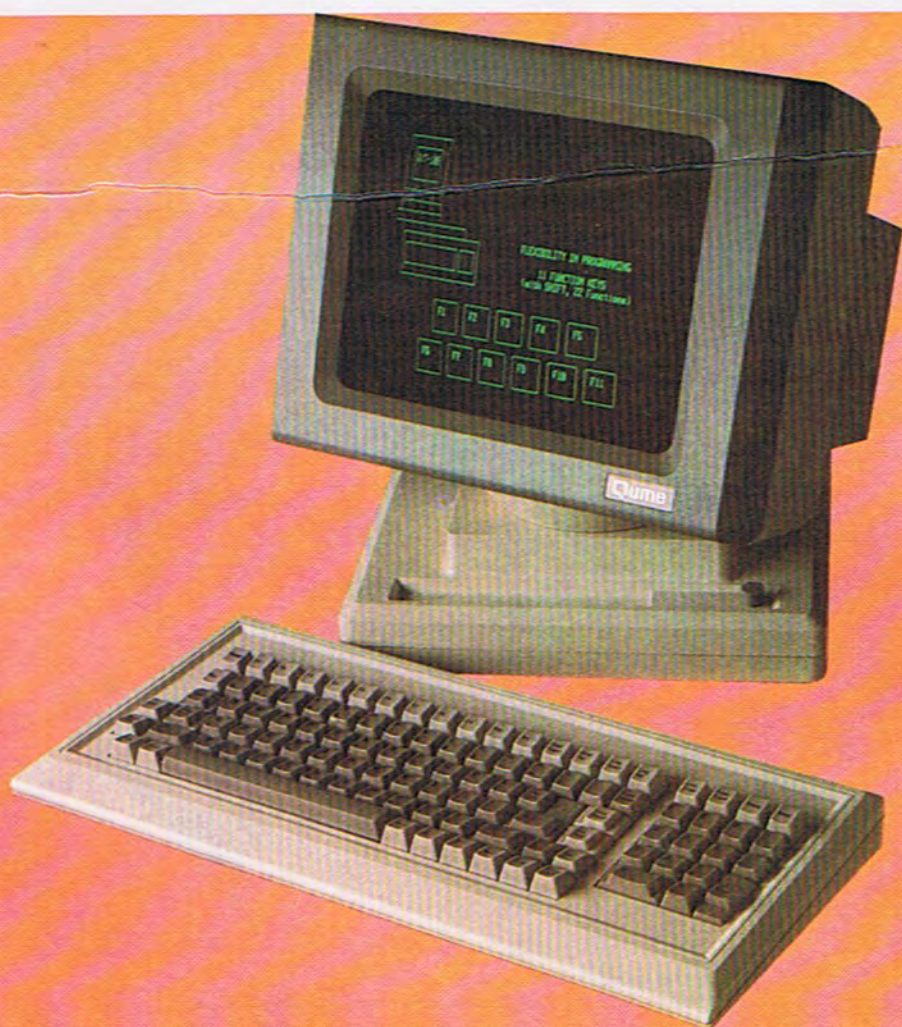
El terminal QVT-108 dispone de 11 teclas de función preestablecida, 22 teclas programables por el usuario, 12 teclas de funciones de edición, así como de dos páginas de memoria de pantalla. El diseño es ergonómico y el formato de pantalla es de 24 líneas por 80 caracteres más una línea adicional de estados.
