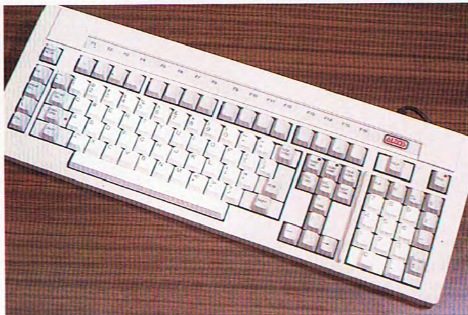
El teclado es de tipo QWERTY conformado por 105 teclas, de las que 16 permiten programar un máximo de 32 funciones, 5 están destinadas al movimiento del cursor y 6 sirven para funciones de edición de textos. El resto de las teclas son de tipo alfanumérico.
