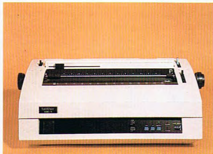
La impresora Brother modelo HR-1 es una impresora de margarita, que se caracteriza por una velocidad de impresión de 16 c.p.s., ancho de carro máximo de 420 mm, tracción por fricción y control por microprocesador, siendo el movimiento del carro realizado mediante un motor paso a paso.
