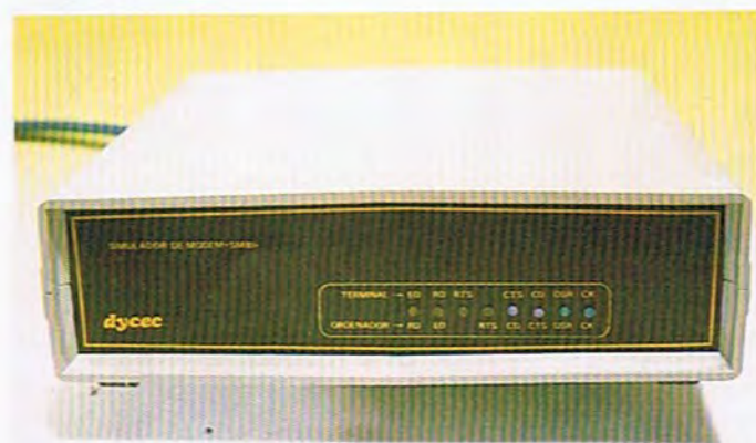
Los simuladores de modem realizan la simulación completa de una conexión con modems. El modelo SM-81 fabricado por DYCEC permite simular velocidades de transmisión, comprendidas entre 300 y 38.400 baudios.
