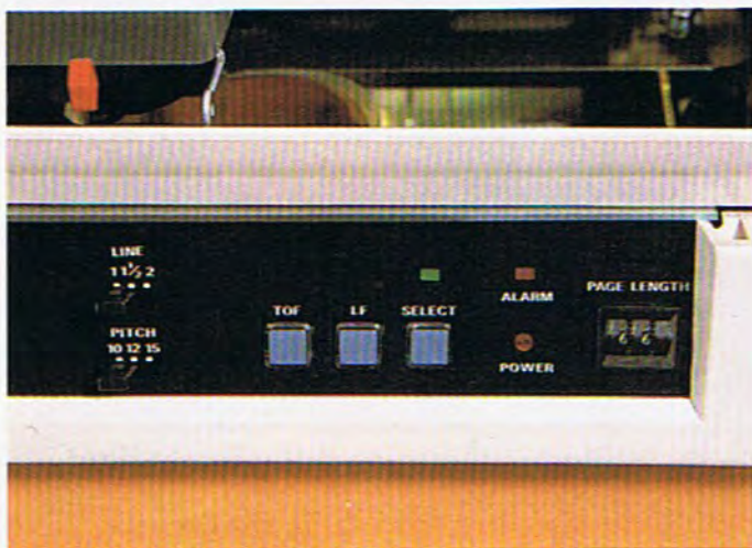
En el panel frontal se dispone de una serie de interruptores que permiten seleccionar la densidad de líneas, la longitud de página y el número de caracteres por línea.
