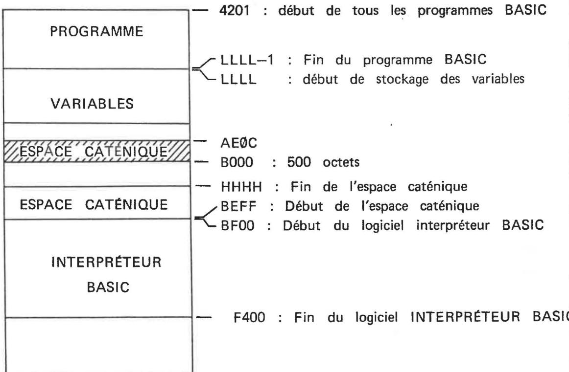
(NOTE : Les 4 paramètres principaux de structure du programme utilisateur BASIC (4201, LLLL, HHHH et BEFF) sont stockés respectivement aux adresses F720, F722, F724 et F726).
