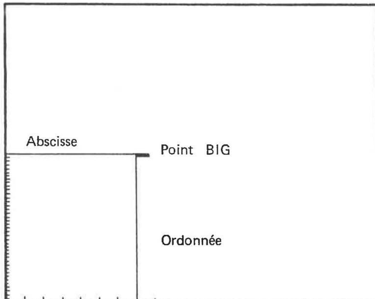
Le point BIG est appelé OCTET c'est-à-dire le point (ou la dernière donnée de façon générale) dont le traitement par HECTOR est le plus souple et le plus rapide. Il se compose en fait de 4 points LITTLE et peut donc prendre une des 256 couleurs composites que forment les différentes combinaisons.
