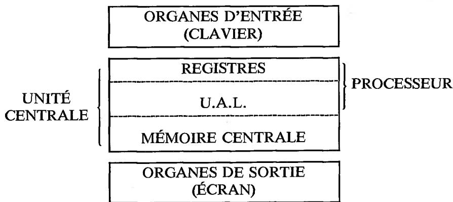
C'est essentiellement la mémoire centrale qui sera utile à notre étude et c'est pour cette raison que les mémoires auxiliaires n'apparaissent pas sur le schéma.
