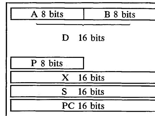
Les registres sont identifiables à des cases mémoire par lesquelles l'information va transiter. Le microprocesseur 6803 contient des registres 8 bits et des registres 16 bits. Les instructions BASIC ne permettent pas l'accès à ces registres et nous ne pourrons jamais, avec la fonction PEEK par exemple, savoir ce que contient tel ou tel registre.
