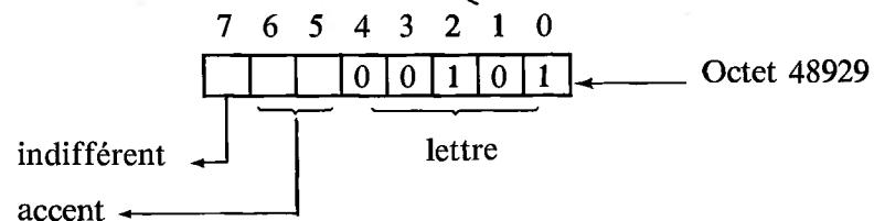
Les cinq bits de droite permettent de déterminer la lettre minuscule sur laquelle on va tracer un accent : *a* est la première, et *z* est la vingt-
