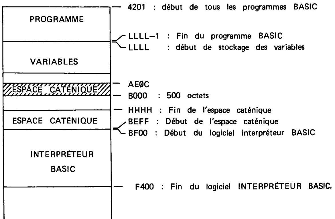
(NOTE : Les 4 paramètres principaux de structure du programme utilisateur BASIC (4201, LLLL, HHHH et BEFF) sont stockés respectivement aux adresses F720, F722, F724 et F726).
