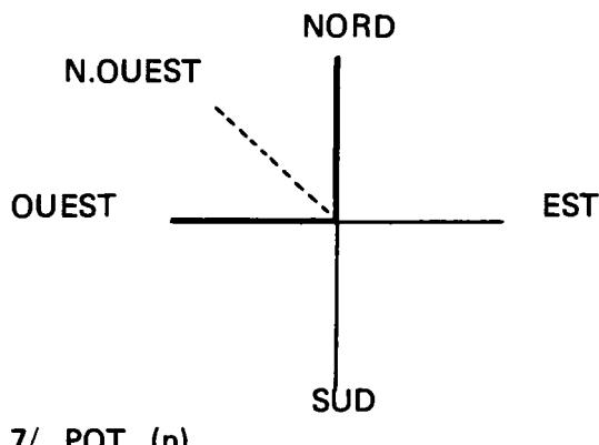
Mécaniquement les contacts assurant les positions diagonales n'existent pas. Ils sont entendus comme les appuis simultanés des contacts qui les entourent.
